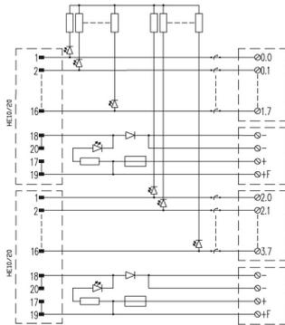
Das Schaltbild entspricht der Ausführung mit LEDs.
