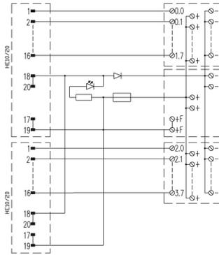
Das Schaltbild entspricht der Ausführung mit LEDs.
