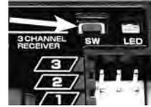
Durch Drücken der Taste "SW" wird im Empfänger automatisch die individuelle Codenummer des Senders gespeichert. Durch diese "Bindung" reagiert der Empfänger nur noch auf die Signale dieses Senders. Dadurch werden Störungen und der Einfluss von anderen Sendern sehr effektiv unterdrückt. Es können mehrere Empfänger an den gleichen Sender "angebunden" werden.
