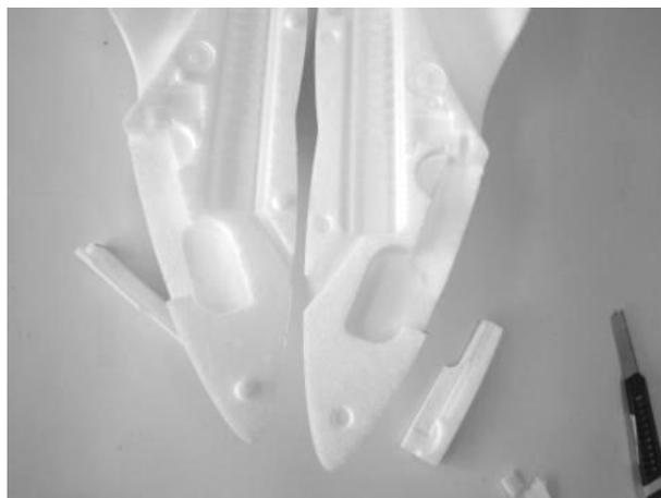
10. Den Rumpf wieder mit Kreppklebeband fixieren, das Bugfahrwerk in den Fahrwerksschacht einlegen und mit einem dünnen Filzschreiber die Kontur der Fahrwerksmechanik auf die Rumpfunterseite übertagen.
