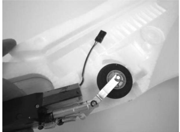
13. Bohren Sie in die in der linken Rumpfhälfte befindlichen Fahrwerksaufnahme mit einem 2 mm Bohrer für die Fahrwerksbefestigungsschrauben vor und montieren Sie das Fahrwerk.
