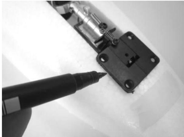
11. Mit einem Fräser der Kontur der Fahrwerksmechanik entlang passgenau die Taschen für die Sperrholzaufnahme ausfräsen und die Aufnahmen einkleben.
