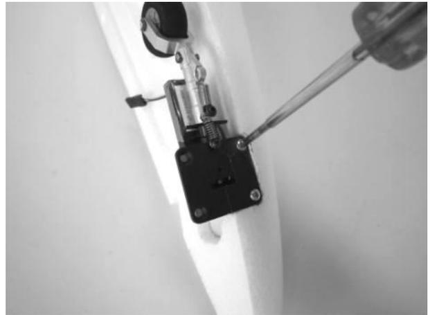
14. Das Fahrwerk mit Hilfe eines Servotesters in die ausgefahrene Position bringen.
