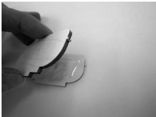
4. Geben Sie nun Sekundenkleber auf die untere Kante der Seitenteile und verkleben den ersten Teil der Fahrwerksaufnahme mit den Seitenteilen.
