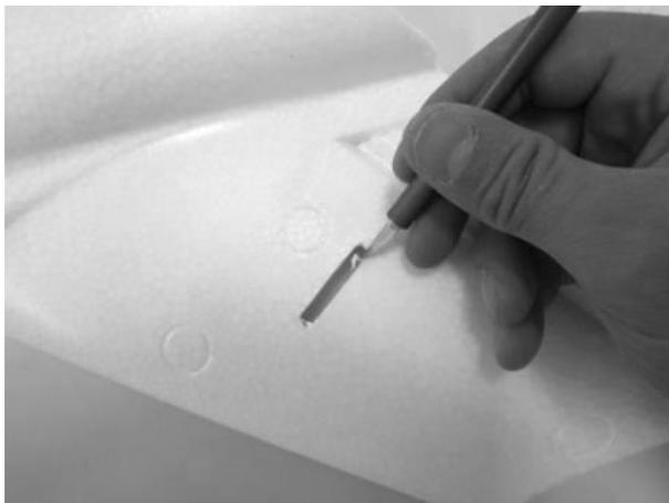
2. Wie beim Einbau der Höhenruder-Servos beschrieben den Servoarm auf das Servo montieren und in die dafür vorgesehene Öffnung in das Seitenleitwerk einkleben.
