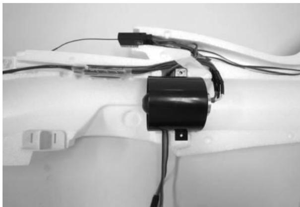
3. Geben Sie nun Sekundenkleber Best.-Nr. 5821 auf die Klebeflächen der Seite mit den RC-Komponenten, die andere Hälfte sprühen Sie mit Aktivator Spray Best.-Nr. 953.150 ein. Führen Sie die Rumpfhälften zusammen und verkleben beide miteinander.
