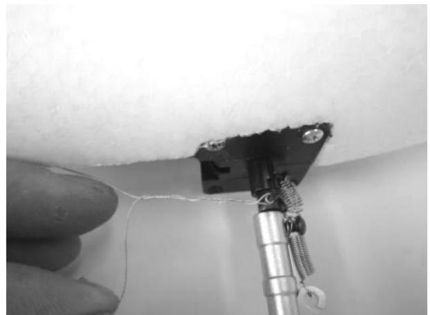
17. Die Litze ist mit Kunststoff ummantelt, wenn Sie die Ummantelung mit erwärmen, verschweißen sich die beiden Stränge miteinander.
