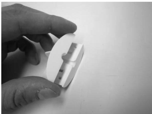
2. Nach dem Zusammenkleben, kleben Sie die Verschraubung in die dafür vorgesehene Öffnung mit Sekundenkleber Best.-Nr. 5821 im Rumpf ein.
