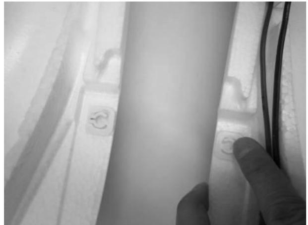
2. Brechen Sie aus dem Spritzbaum die Haltebolzen rechts und links heraus und verkleben Sie diese in der Akkuschachtabdeckung wie auf den Bildern zu sehen. Die Abdeckung kann dann später, wenn der Rumpf zusammengeklebt wurde, einfach von oben in den Akkuschacht eingeschoben werden und rastet dann durch sanftes Drücken in den Klippverschlüssen ein.
