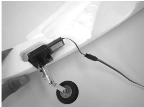
15. Wie auf den Bildern zu sehen den Servoarm auf dem Servo montieren und das Servo in Nullstellung bringen. Die beim Fahrwerk beiliegende Litze so durch den Servoarm schlaufen, dass die Litze an beiden Seiten gleichlang heraussteht.
