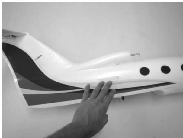
6. Ziehen Sie nun den Aufkleber bis zum Kreppklebeband ab und legen diesen ohne ihn zu knicken nach hinten um. Schneiden Sie dann das Trägerpapier mit einer Schere ab.
