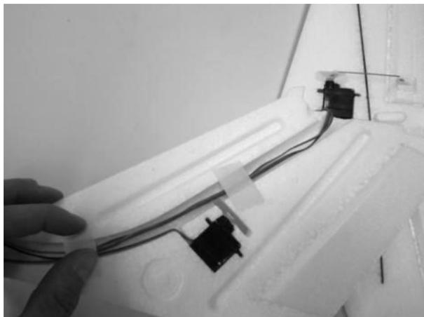
2. Stecken Sie nun alle Kabel wie in der Anleitung ihres Senders beschrieben in den Empfänger ein und führen Sie die Verlängerungskabel Best.-Nr. 3935.32 die für die Querruderservos bestimmt sind, hinter dem Impeller im Kabelschacht hindurch.
