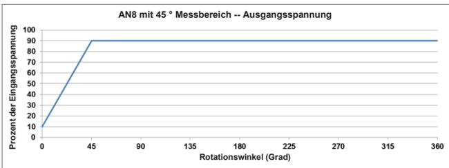
Diese Tabellen zeigen die Ausgangsspannung in Prozent der Eingangsspannung für den angegebenen Rotationswinkel. Beispiel: 180 ° Messbereich, Magnet gedreht um 135 °, Ausgangsspannung beträgt 70 % der Eingangsspannung (zu sehen an den gestrichelten Linien im Diagramm oben).
