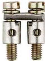
Bei dieser Querverbindung sind Querverbindungsflasche, Querverbindungshülse und Befestigungsschraube unverlierbar vormontiert. Alle Einzelteile sind auf Anfrage auch separat verfügbar. Die so vormontierten Querverbinder werden bei der Montage nur noch in den Querverbindungskanal in der Klemmenmitte eingelegt und festgeschraubt.
