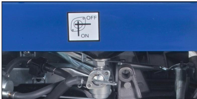
Abb. 4.6: Kraftstoffhahn schließen
