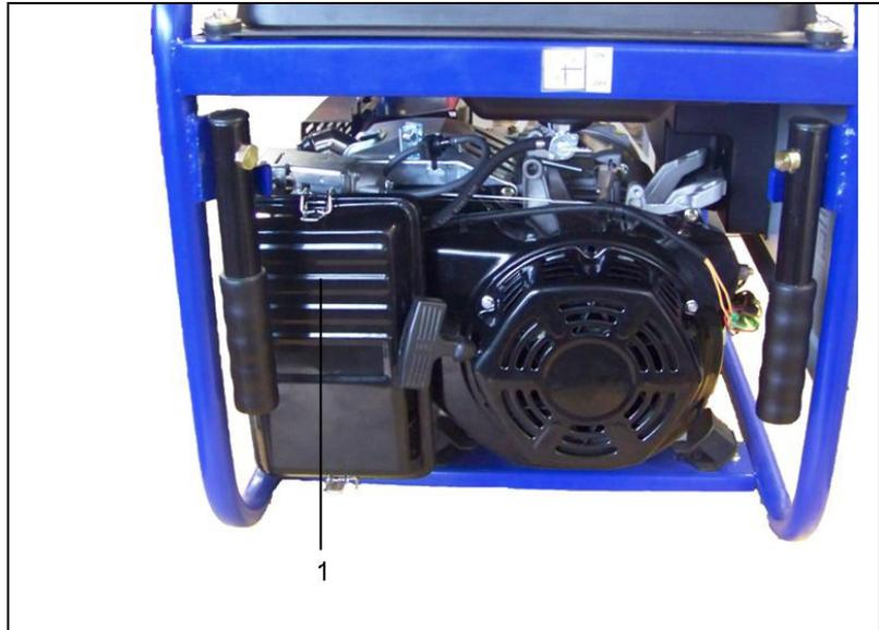
Abb. 4.8: Luftfilter entfernen
