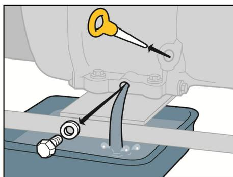
Abb. 4.5: Öl-Ablassschraube entfernen
