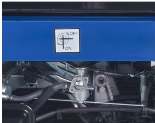
Abb. 4.1: Kraftstoffhahn öffnen / schließen
