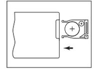
Legen Sie eine neue Batterie mit dem Pluspol (+) nach oben hinein. Führen Sie das Fach wieder ins Gehäuse ein.
