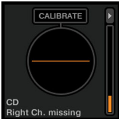
Abb. 6.6 – Ein fehlender Kanal.
