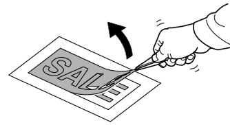
Zum Entfernen kleiner Folienreste verwenden Sie am besten eine Pinzette.
