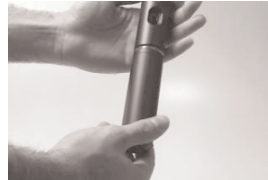
Abb. 1 – Aufschrauben des Gehäuses
