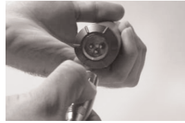
Abb. 5 – Anschluss des XLR-Kabels
