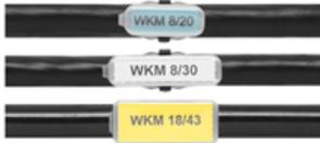
**WKM** ist ein Markierer für hohe Belastungen mit sicherem Halt am Leiter oder Kabel. Die transparente Tasche gewährleistet einen sicheren Schutz der Kennzeichnung vor Umgebungseinflüssen. Die Befestigung per Kabelbinder erlaubt nahezu sämtliche Leiterquerschnitte. **WKM** gestattet eine Vielzahl an Beschriftungsmöglichkeiten, so etwa Laserdruck, Matrixdruck oder Beschriftungsstift STI auf Papier oder Polyesteretiketten.
