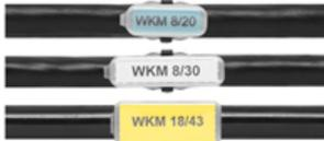
**WKM** ist ein Markierer für hohe Belastungen mit sicherem Halt am Leiter oder Kabel. Die transparente Tasche gewährleistet einen sicheren Schutz der Kennzeichnung vor Umgebungseinflüssen. Die Befestigung per Kabelbinder erlaubt nahezu sämtliche Leiterquerschnitte. **WKM** gestattet eine Vielzahl an Beschriftungsmöglichkeiten, so etwa Laserdruck, Matrixdruck oder Beschriftungsstift STI auf Papier oder Polyesteretiketten.
