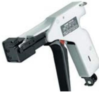
Das **WSM-Tool** ist ein Werkzeug mit dem Stahlkabelbinder festgezogen werden. Zwei verschiedene Ausführungen sind vorhanden: Mit der **Automatik**-Ausführung lassen sich Kabelbinder festziehen und die überstehenden Binderenden in einem Arbeitsgang abschneiden. Das WSM-Tool in der Variante **Manuell** dient ausschließlich zum Festziehen der Kabelbinder, danach ist das Kabelband per 90°-Drehung abzusetzen.
