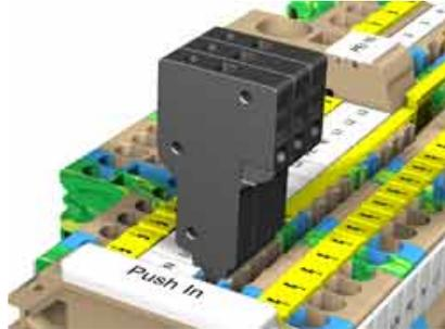
Der verrastende Testadapter (PTA) wird als Einzelscheibe sowie als Testadapterleiste zu Spannungsmessungen in Schaltschränken eingesetzt. Mit ihm werden Prüfungen an konfektionierten Reihenklemmen komfortabel und rationell durchgeführt. Der Testadapter wird einfach in den Querverbindungskanal der Reihenklemme gerastet. Auf diesem Weg wird die potenzialführende Stromschiene kontaktiert.
