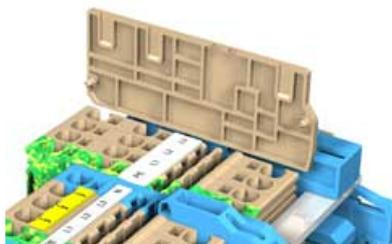
Halteplatten, die in der P-Reihe auch die Funktion der Abschlussplatten übernehmen, müssen beim Einsatz der 10 x 3 Sammelschiene alle 200 mm gesetzt werden.
