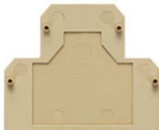
Die letzte Klemme einer Klemmenleiste muss bis auf wenige Ausnahmen mit einer Abschlussplatte Typ AP abgedeckt werden. Innerhalb einer Klemmenleiste mit verschiedenen großen Klemmen sind ebenfalls Abschlussplatten einzufügen. Die Außenabmessungen der Abschlussplatten entsprechen den Hüllmaßen der zugehörigen Klemme. Die Abschlussplatte wird durch den Endwinkel gehalten.
