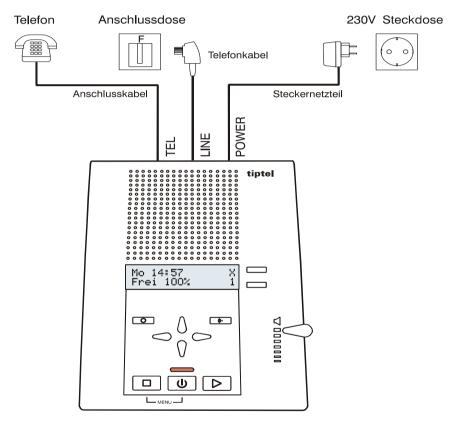
Für diese Anschlussmöglichkeit wird vorausgesetzt, dass die Anschlüsse des Telefons auf dem mittleren Anschlusspaar des Telefonkabels liegen. Dies ist der Fall wenn das Telefon die Vorschriften TBR21 oder ETSI ES 203 021 erfüllt. Falls auf Ihrer Telefondose die Kontakte Erde und Wecker benutzt werden, verwenden Sie ausschließlich ein zweiadriges Telefonkabel.
