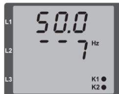
Abb. Anzeige der Netzfrequenz (50.0) und der Drehfeldrichtung
