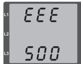
Abb. Warnmeldung mit Nummer 500 (Netzfrequenz)
