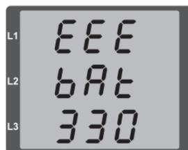
Abb. Uhren-/Batteriefehler mit Nummer 330 (Uhr steht und muss gestellt werden).
