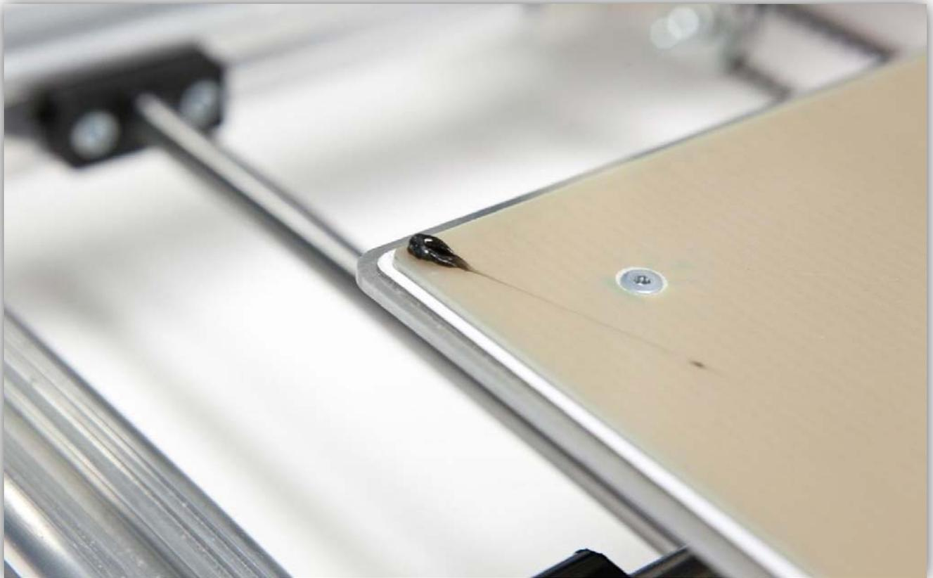
Beachten Sie, dass die erste Schicht fest auf dem HEIZBETT hält. Wurde die Z-ACHSE korrekt kalibriert, dann sollte das OK sein. Es ist kein Problem wenn die erste Schicht mit ein bisschen zu viel Kunststoff gedruckt worden ist. Ab der dritten Schicht sollte alles aber homogen aussehen.
