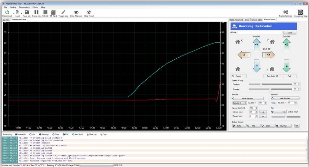
Hat das Heizbett seine Temperatur erreicht (50°C), dann positioniert der Drucker alle Achsen in der Startposition. Dies ist normal. Hat der Extruder die Temperatur erreicht (190°C), dann startet der Druck. Zuerst überprüft der Drucker, ob das Filament genügend geschmolzen ist, und lässt ein bisschen Kunststoff auf dem 0, 0, 0 Punkt tropfen. Sie können es entfernen.
