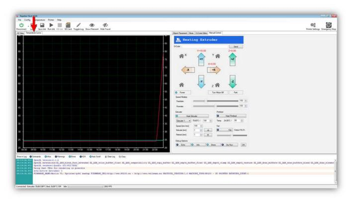
Eine Kurve mit der Extruder-Temperatur (ROT) und der Heizbett-Temperatur (BLAU) wird angezeigt. Die rote Linie steigt bis sie die Temperatur im Kästchen (190°C) erreicht. Die aktuelle Temperatur können Sie auch hier kontrollieren:
