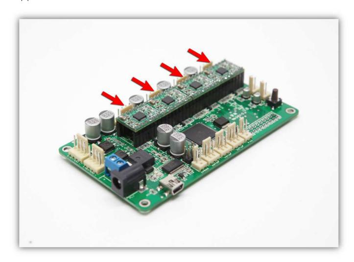
Diese Treiber kontrollieren den Strom, der durch jeden Motor fließt. Kalibrieren Sie jeden Motor, damit diese korrekt funktionieren. Nehmen Sie ein Multimeter und einen keramischen Schraubendreher (mit einem normaler Schraubendreher geht es auch, aber seien Sie dann sehr vorsichtig und berühren Sie nur das Trimmpotentiometer der Treiberplatten, um Kurzschluss zu vermeiden).
