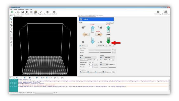
Die Z-ACHSE bewegt sich 10 mm nach **UNTEN**. Alles sollte reibungslos funktionieren. Bewegt sich die Z-ACHSE nicht oder bewegt diese sich in die andere Richtung, dann haben Sie etwas falsch angeschlossen. Suchen Sie den Fehler und schließen Sie korrekt an.
