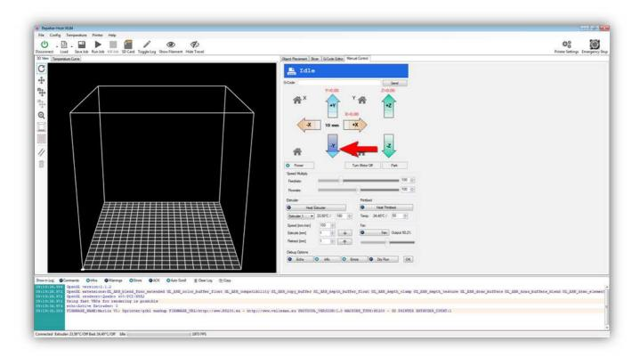
Die Y-ACHSE bewegt sich 10 mm nach **HINTEN** }. Alles sollte reibungslos funktionieren. Bewegt sich die Y-ACHSE nicht oder bewegt diese sich in die andere Richtung, dann haben Sie etwas falsch angeschlossen. Suchen Sie den Fehler und schließen Sie korrekt an.
