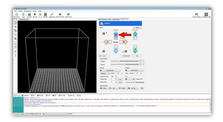
Die Y-ACHSE bewegt sich 10 mm nach **VORNE** . }. Alles sollte reibungslos funktionieren. Bewegt sich die Y-ACHSE nicht oder bewegt diese sich in die andere Richtung, dann haben Sie etwas falsch angeschlossen. Suchen Sie den Fehler und schließen Sie korrekt an.
