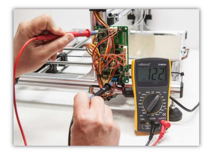
Regeln Sie das kleine Trimmpotentiometer des Treibers mit dem keramischen Schraubendreher bis Sie **0.425V** messen.
