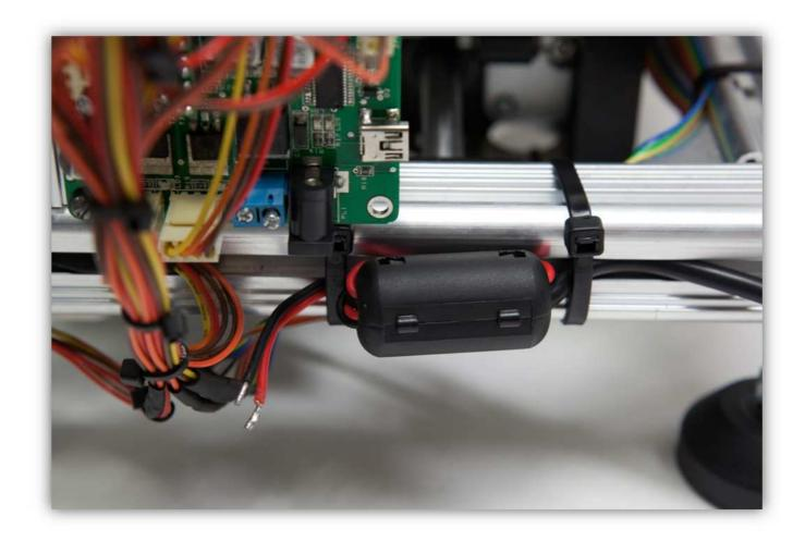
Verbinden Sie die Adern mit der blauen Schraubklemme. **Beachten Sie die Polarität. Die rote Ader ist positiv und die schwarze Ader ist negativ.**
