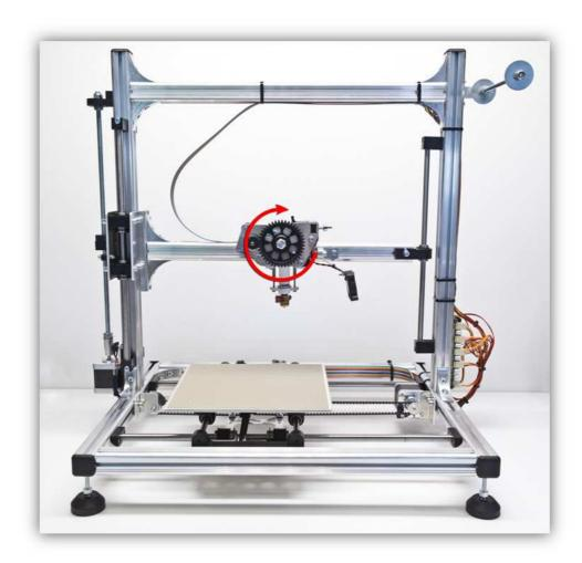
Der Extruder-Motor sollte reibungslos drehen. Bewegt sich das GROßE ZAHNRAD nicht oder bewegt es sich in die andere Richtung, dann haben Sie etwas falsch angeschlossen. Suchen Sie den Fehler und schließen Sie korrekt an.
