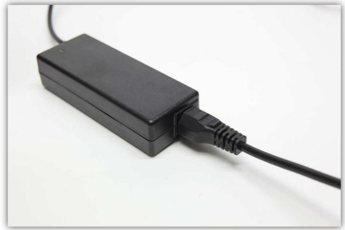
Weil dies ein Bausatz ist, ist es möglich, dass der AC-Stecker sich nicht für Ihr Land eignet. Ist dies der Fall, kaufen Sie dann den richtigen Stecker bei ihrem Händler und schließen Sie ihn an (siehe Abb.). Die Stromversorgung eignet sich für folgende Spannungen: 100-240V 50-60Hz.
