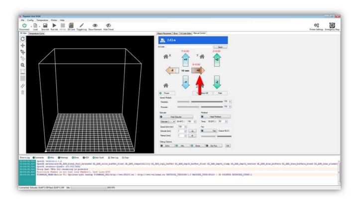
Die X-ACHSE bewegt sich 10 mm nach **LINKS** . Alles sollte reibungslos funktionieren. Bewegt sich die X-ACHSE nicht oder bewegt diese sich in die andere Richtung, dann haben Sie etwas falsch angeschlossen. Suchen Sie den Fehler und schließen Sie korrekt an.
