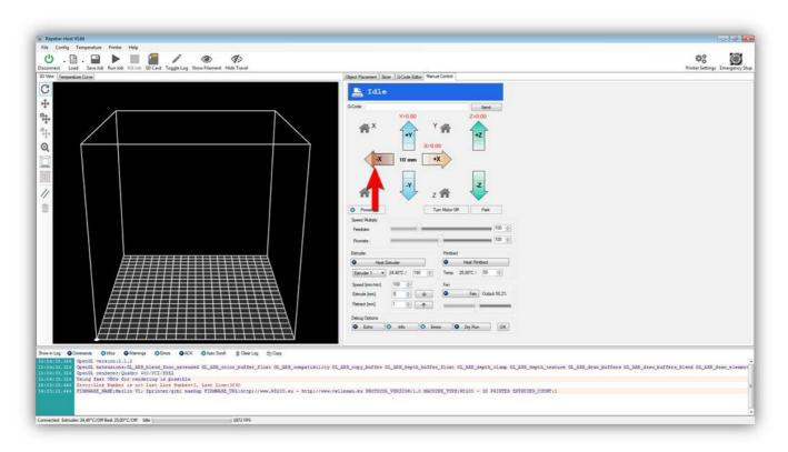
Die X-ACHSE bewegt sich 10 mm nach **RECHTS** . Alles sollte reibungslos funktionieren. Bewegt sich die X-ACHSE nicht oder bewegt diese sich in die andere Richtung, dann haben Sie etwas falsch angeschlossen. Suchen Sie den Fehler und schließen Sie korrekt an.
