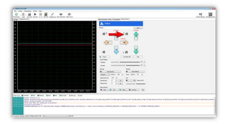
Sobald Sie diese Taste drücken, bewegt sich das Druckbett in die Richtung des Microschalters, auf den Sie Ihren Finger gelegt haben. Drücken Sie schnell auf den Microschalter. Funktioniert der Microschalter korrekt, dann stoppt das Druckbett.
