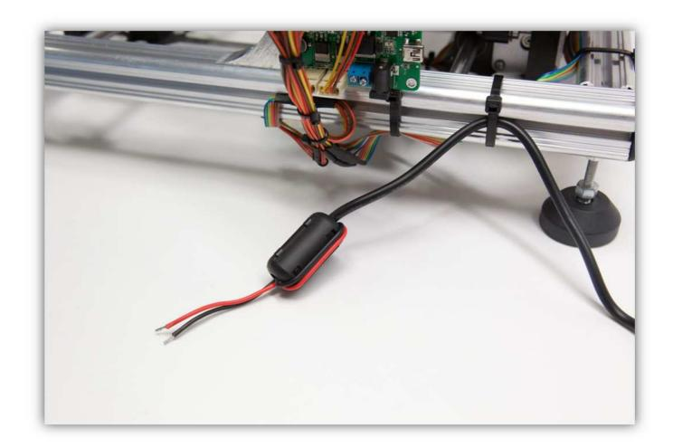
Stecken Sie die Ader durch den zweiten Kabelbinder.
