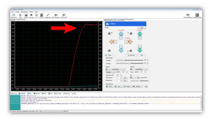
Nun können wir den Extruder-Motor testen. Aus Sicherheitsgründen kann der Motor nicht drehen wenn der Extruder kalt ist. Kontrollieren Sie zuerst nachfolgende Werte:
