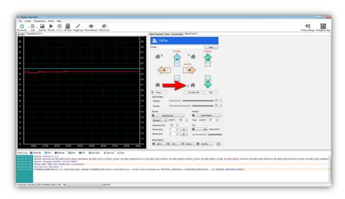
Sobald Sie diese Taste drücken, bewegt sich den Z-TISCH in die Richtung des Microschalters, auf den Sie Ihren Finger gelegt haben. Drücken Sie schnell auf den Microschalter. Funktioniert der Microschalter korrekt, dann stoppt der Z-TISCH.
