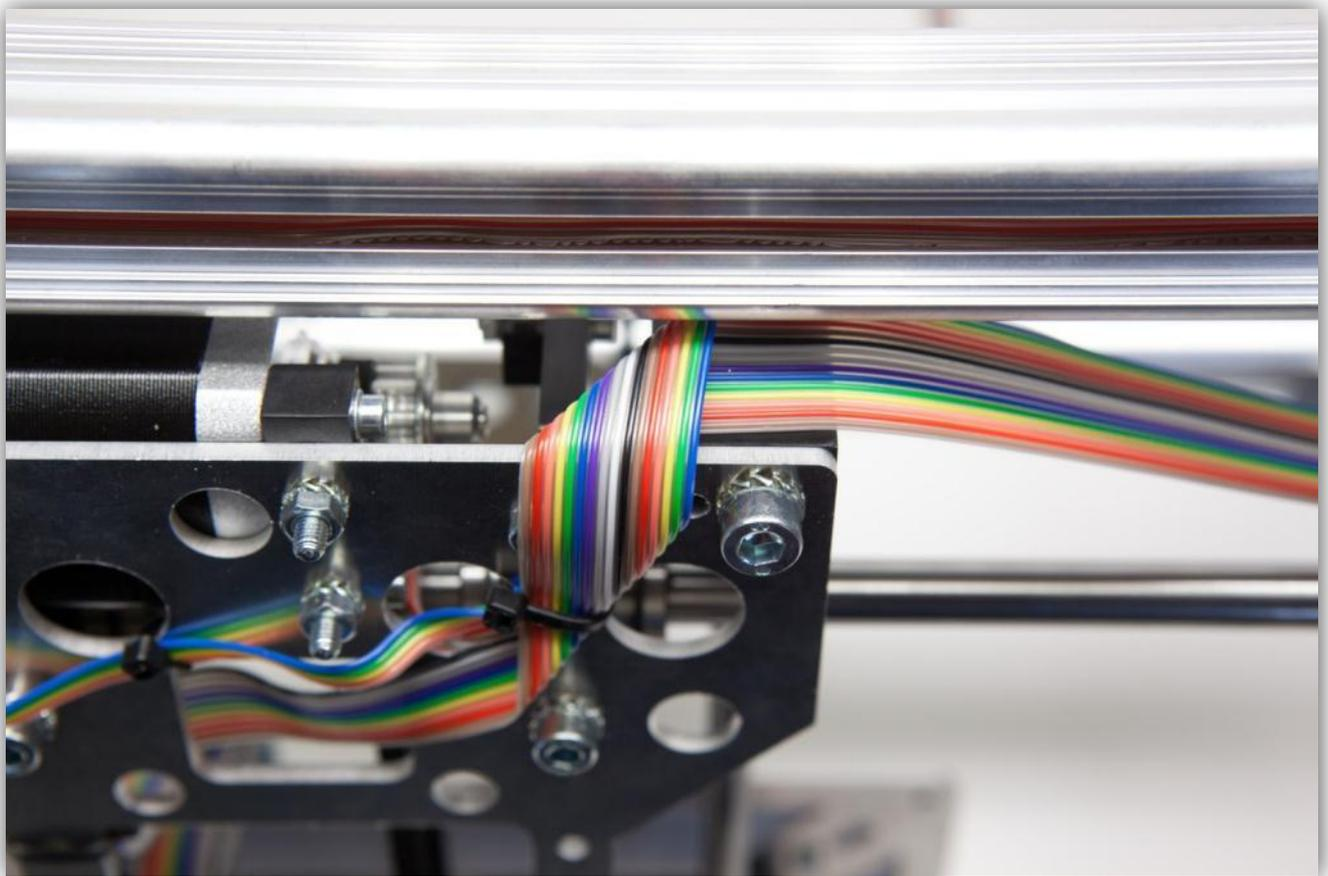
Befestigen Sie das Kabel so, dass es sich parallel mit dem Rahmen befindet.
