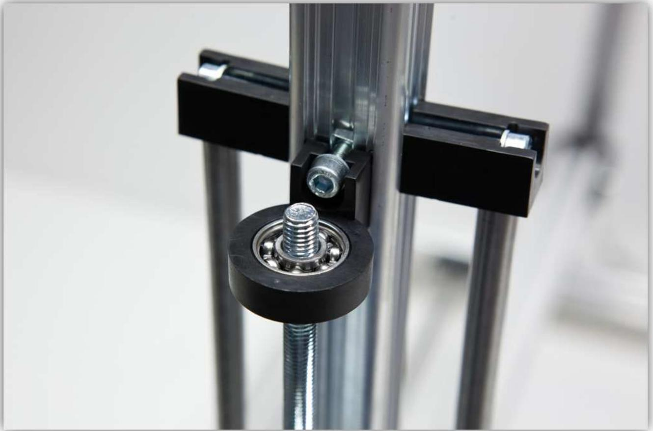
Befestigen Sie eine M8-Sicherungsmutter an der Gewindestange (siehe Abb.).
