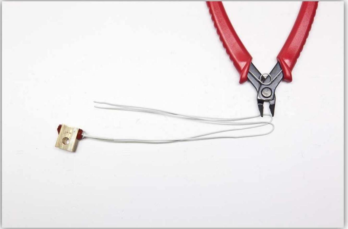
Isolieren Sie alle Adern, die Sie abgeschnitten haben, ab (5mm (0.2")). Nehmen Sie die zwei losen Adern.
