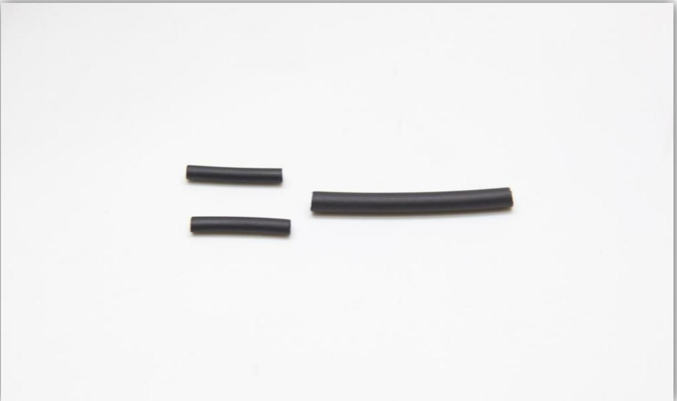
Schieben Sie den mittelgroßen Schrumpfschlauch über die 2 Litzen der Steckbuchse.
