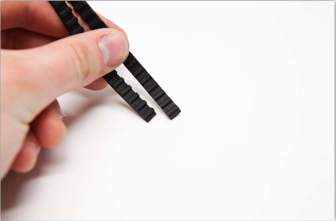
Vom Stück, den Sie gerade abgeschnitten haben, messen Sie einen Stuck von **63.5cm (25") oder 127 Zähnen**. **Diese Abmessungen sind sehr wichtig. Zählen Sie die Zähne und messen Sie nochmals, bevor Sie ein Stück abschneiden.**
