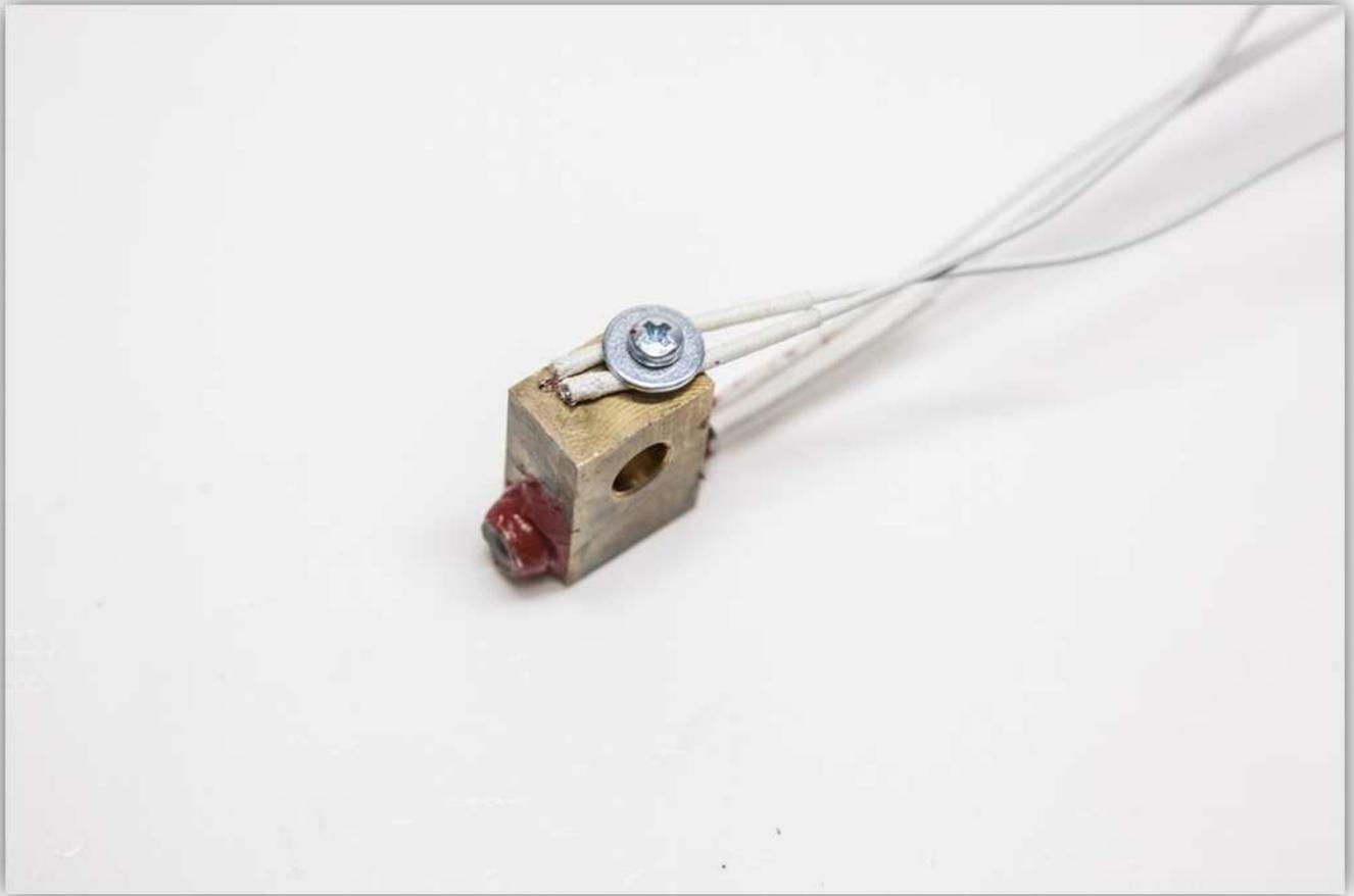
Binden Sie die Adern des NTC und des Heizblocks mit einem kleinen Kabelbinder zusammen.
