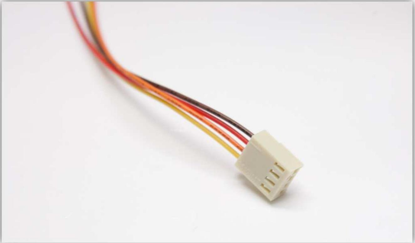
Stecken Sie die Buchse in den Anschluss auf der Controllerplatine (z-MOTOR).
