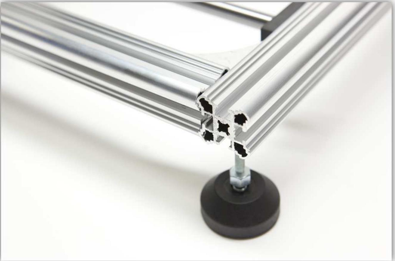
Liegt das ALUMINIUMPROFIL bündig mit dem Rahmen, dann ziehen Sie alle Schrauben der MONTAGEWINKEL an.
