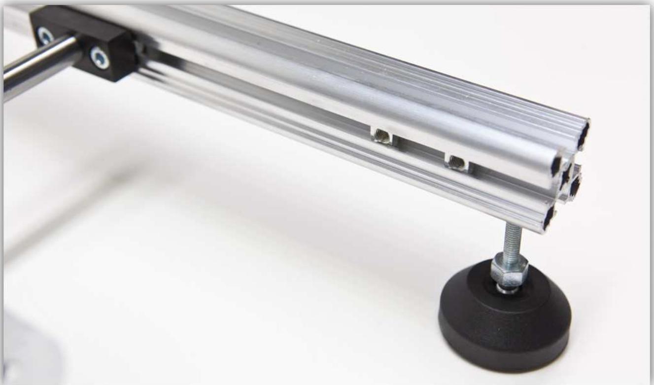
Schieben Sie eine M5-Vierkantmutter in das linke ALUMINIUMPROFIL (siehe Abb.).
