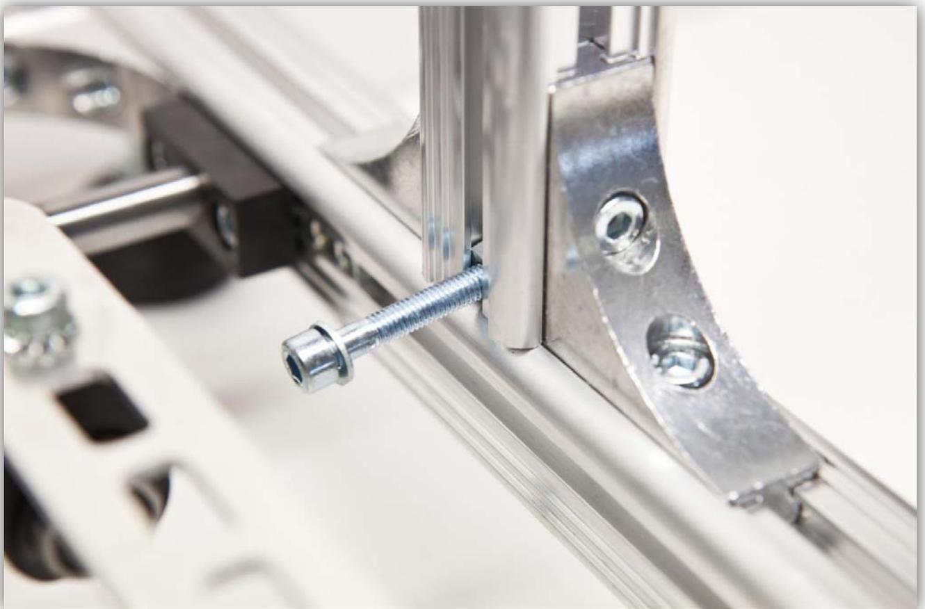
Schieben Sie eine der KLEINEN Z-ROHRKLEMMEN über diese Schraube und ziehen Sie diese Schraube so fest, dass der Teil sich etwa 6cm (2.36") vom Rahmen befindet.
