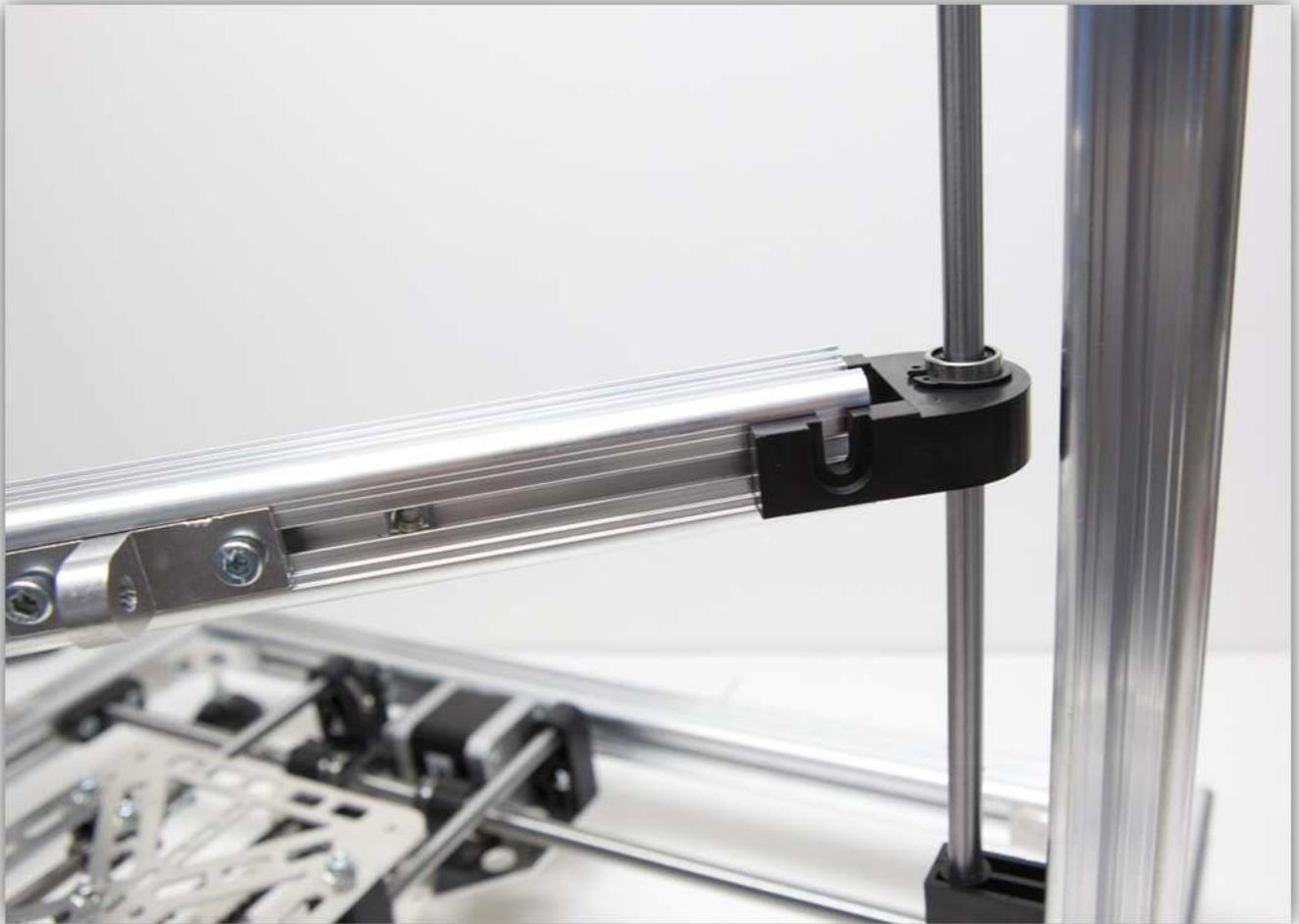
Schieben Sie die zwei MONTAGEWINKEL in den Z-TISCH. Seien Sie vorsichtig und beachten Sie, dass keine M5-Vierkantmutter aus dem Profil gleitet.
