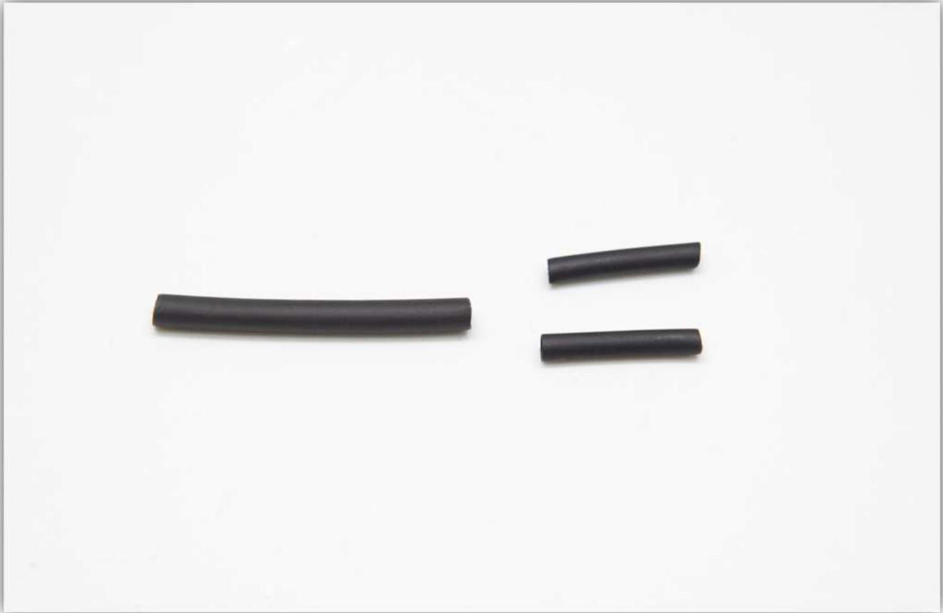
Schieben Sie den mittelgroßen Schrumpfschlauch über die 2 Litzen des NTC. **Vergewissern Sie sich davon, dass es sich um die Adern des NTC handelt.**
