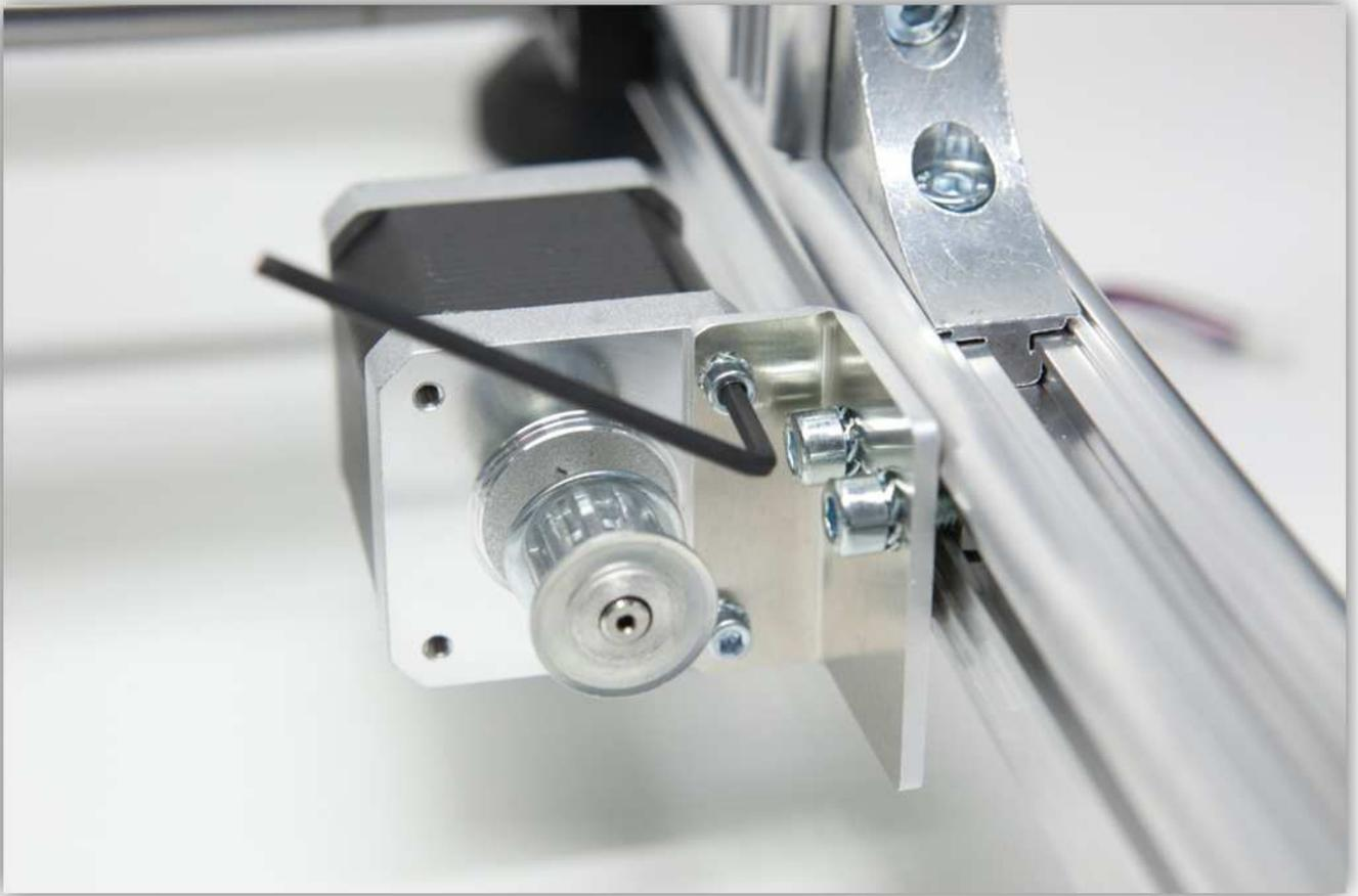
Beachten Sie, dass die Riemenscheibe des Motors und die zwei X-RIEMKLEMMEN bündig liegen. Schieben Sie, um die Riemenscheibe auszurichten und ziehen Sie die Schrauben fest. **Beachten Sie, dass der Teil völlig ausgerichtet ist.**
