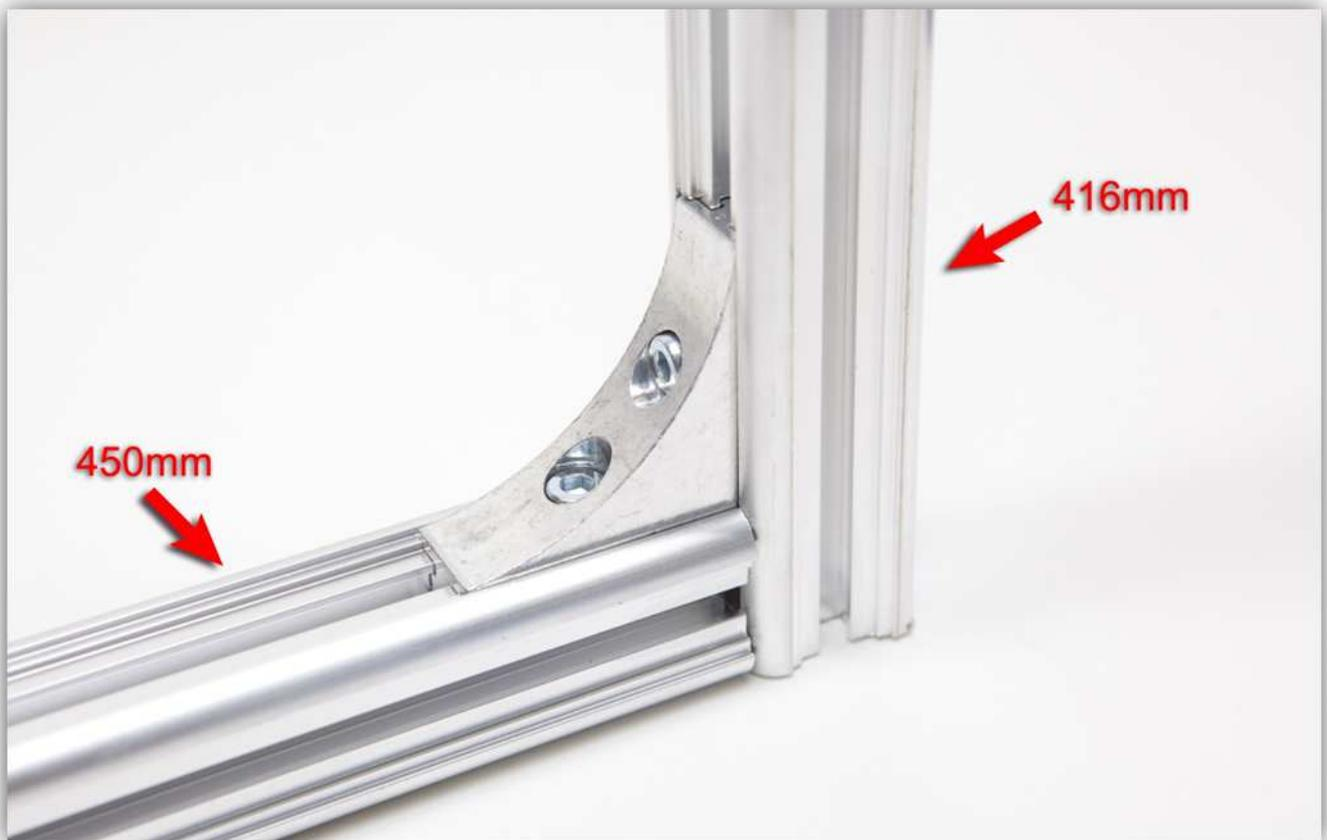
Ziehen Sie alle Schrauben fest an und beachten Sie, dass alle Winkel rechte Winkel sind ( $90^\circ$ ) und, dass alle ALUMINIUMPROFILE bündig liegen.
