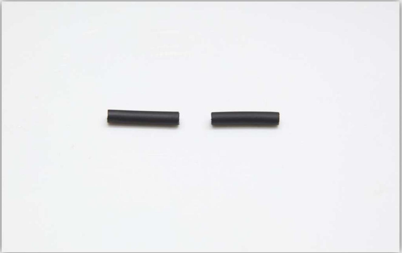
Schieben Sie die 2 mittelgroßen Schrumpfschläuche über die **rote** und die **braune** Ader des Flachbandkabels.
