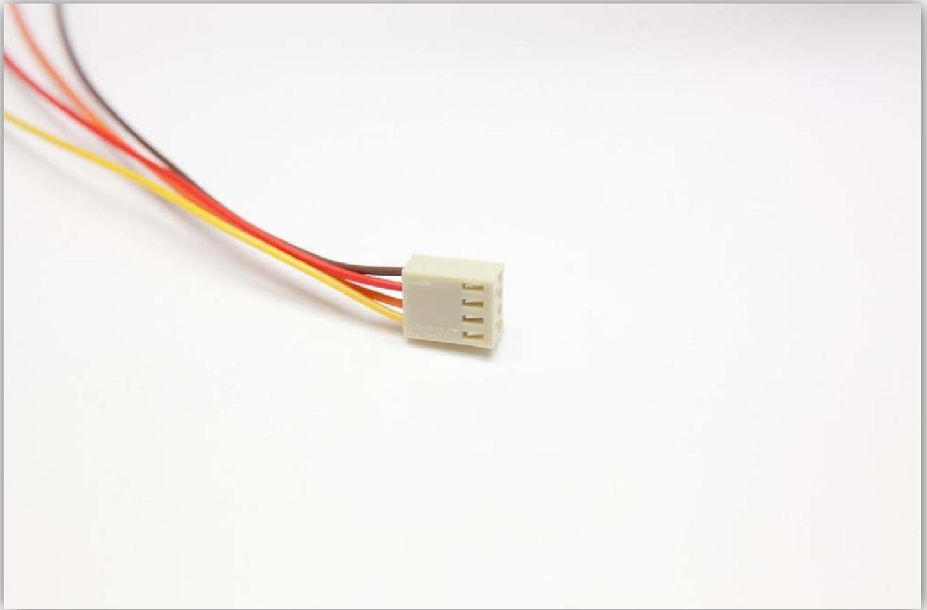
Stecken Sie die Buchse in den Anschluss auf der Controllerplatine (E-MOTOR).
