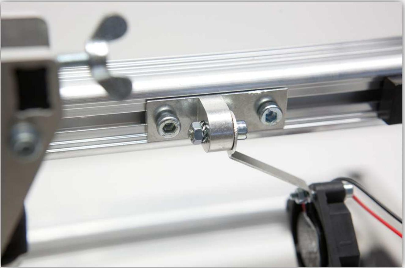
Ziehen Sie diese Schraube fest und beachten Sie, dass die LÜFTERHALTERUNG vertikal installiert ist.
