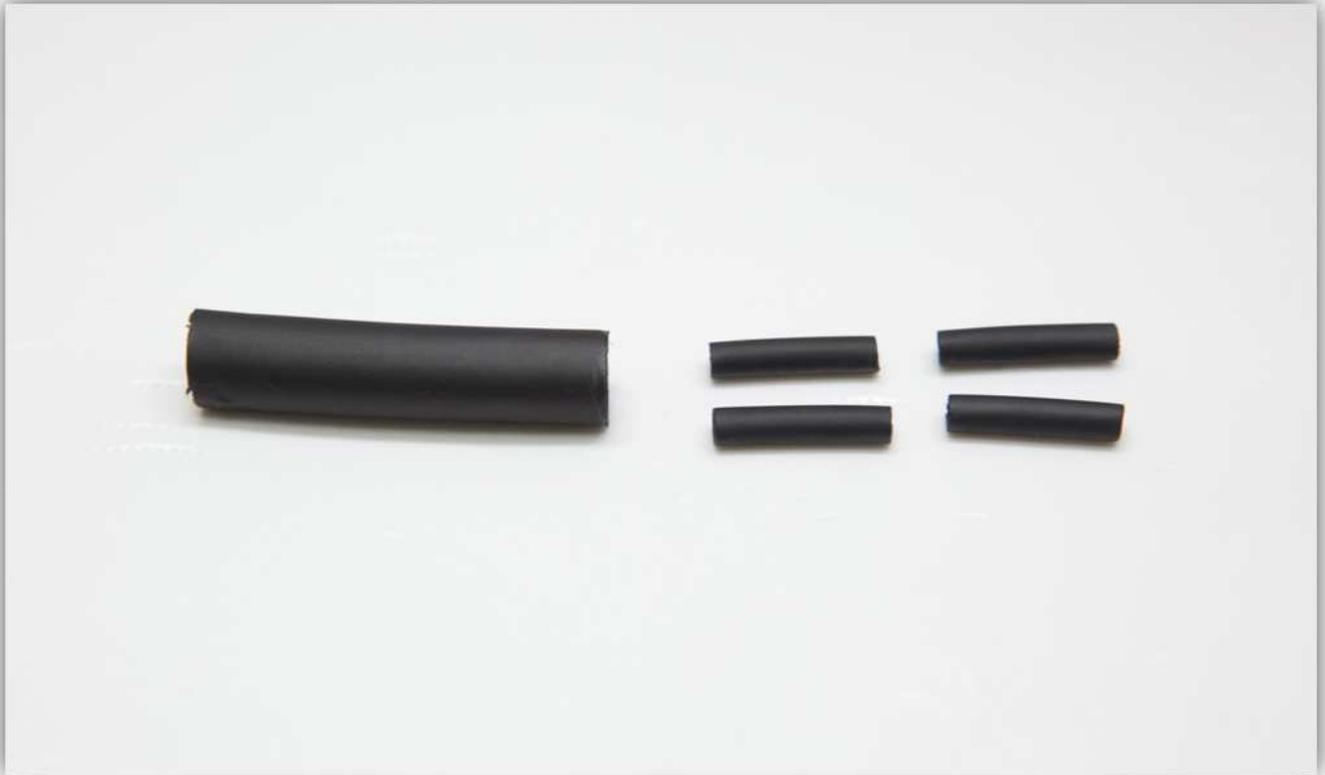
Schieben Sie den großen Schrumpfschlauch über die 4 Litzen der Steckbuchse.
