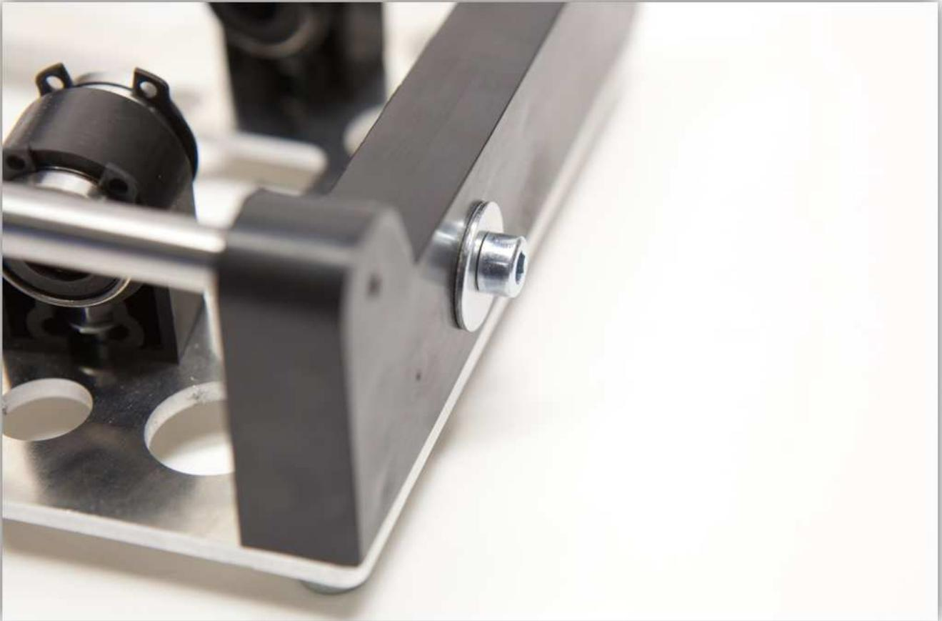
Befestigen Sie eine kleine M5-Unterlegscheibe und eine M5-Sicherungsmutter am anderen Ende. **Ziehen Sie die Sicherungsmutter nicht fest. Vergewissern Sie sich nur davon, dass diese nicht fallen kann. Wir kommen später hierauf zurück.**
