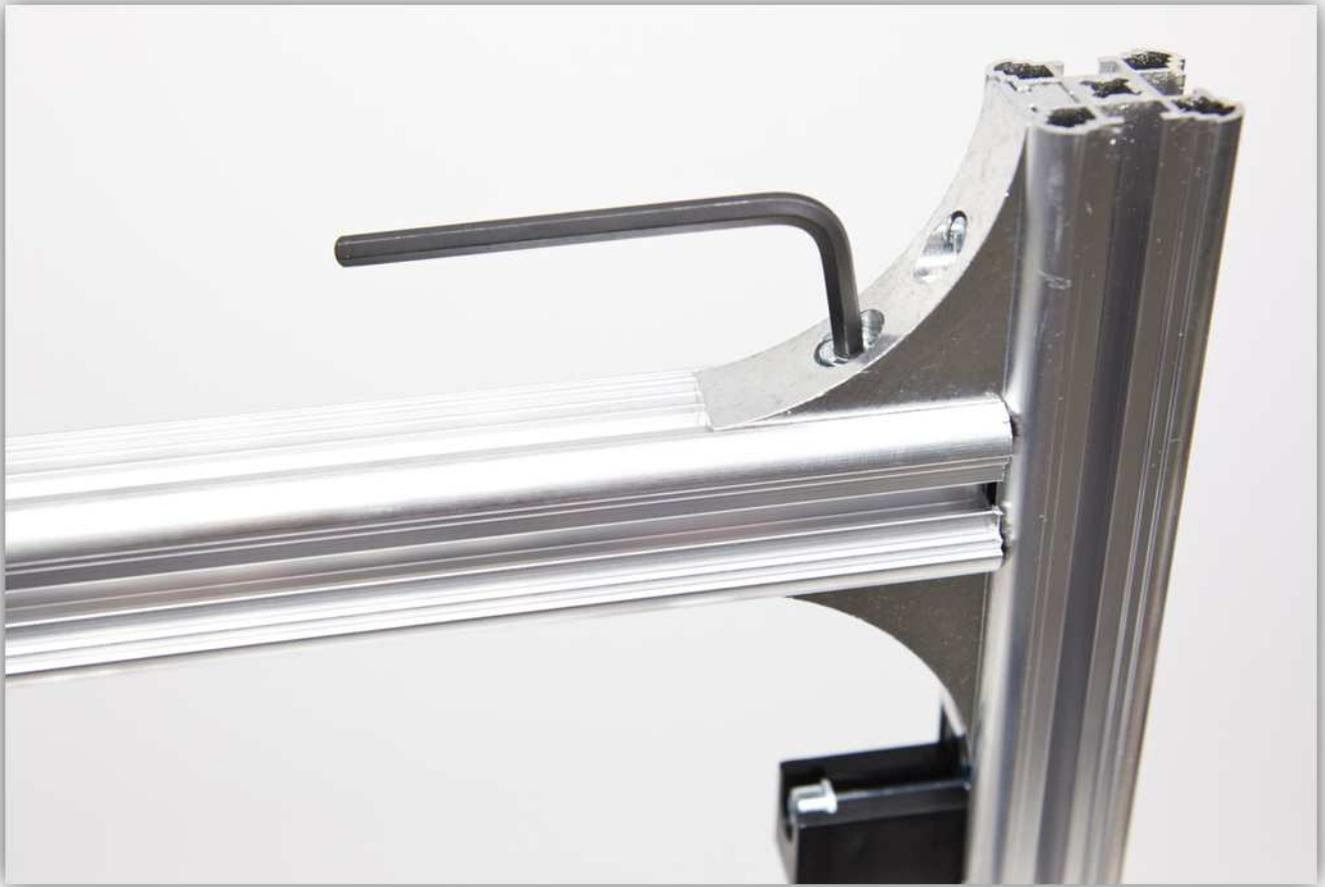
Schieben Sie die zwei Vierkantmuttern der Vorder- und Rückseite des Extruderarms in die Richtung der KLEINEN Z-LAGERKLEMME.
