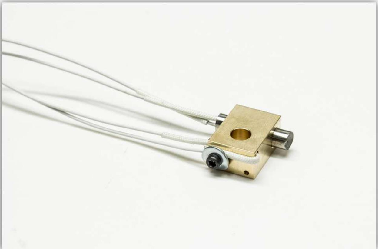
Schieben Sie die große Unterlegscheibe über den kupfernen Zylinder.
