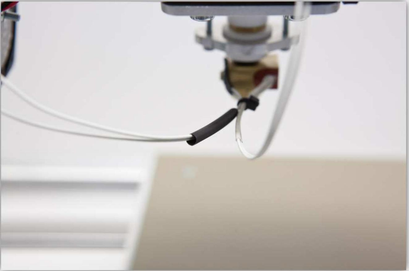
Schieben Sie den mittelgroßen Schrumpfschlauch über die 2 Litzen des NTC.
