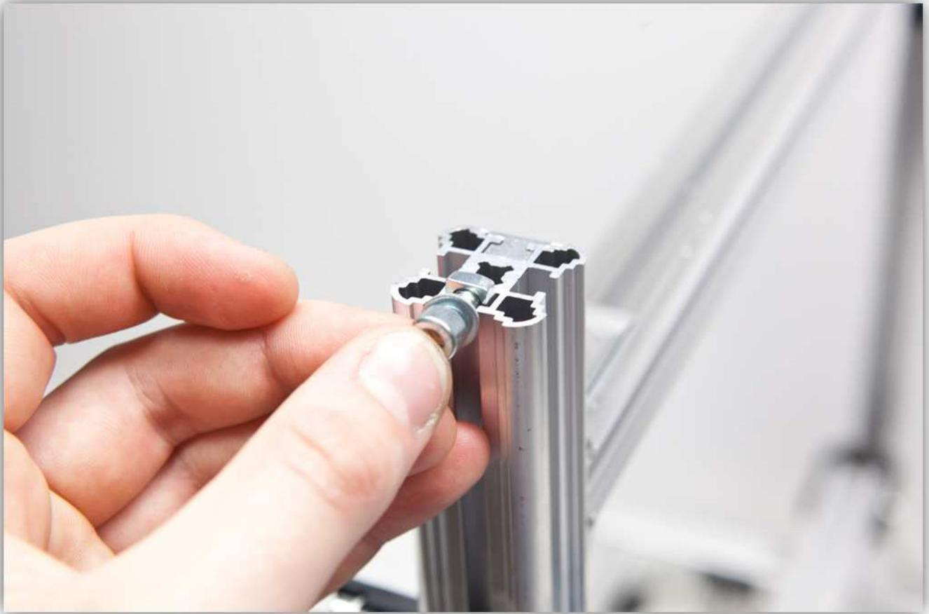
Schieben Sie den montierten Teil in die Z- STANGENFÜHRUNG und ziehen Sie die Schraube fest. Achten Sie aber darauf, dass diese noch nach oben und nach unten bewegen kann.
