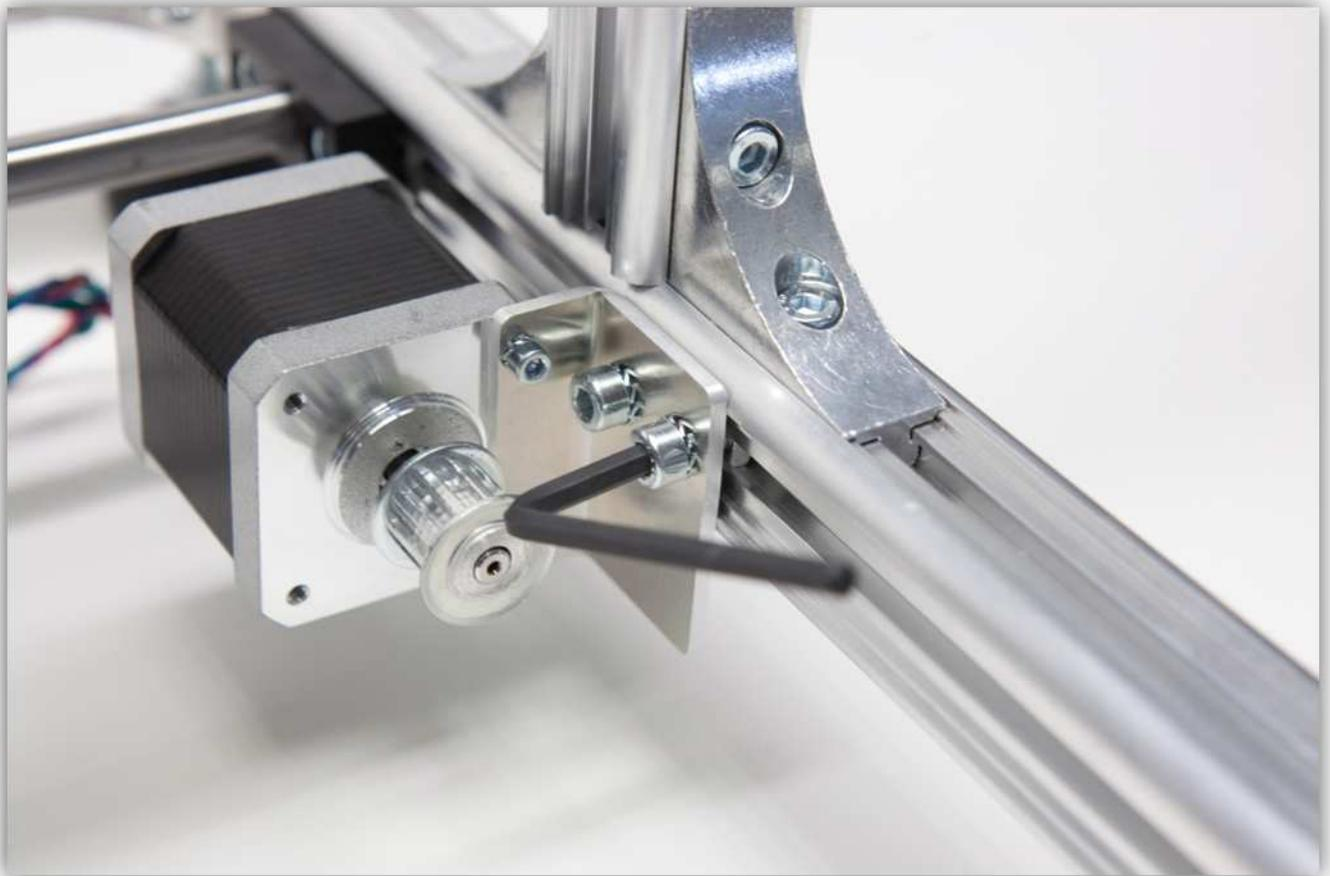
Klemmen Sie das Ende des Riemens in die X-RIEMENKLEMME (ganz links). Ziehen Sie die Muttern fest.
