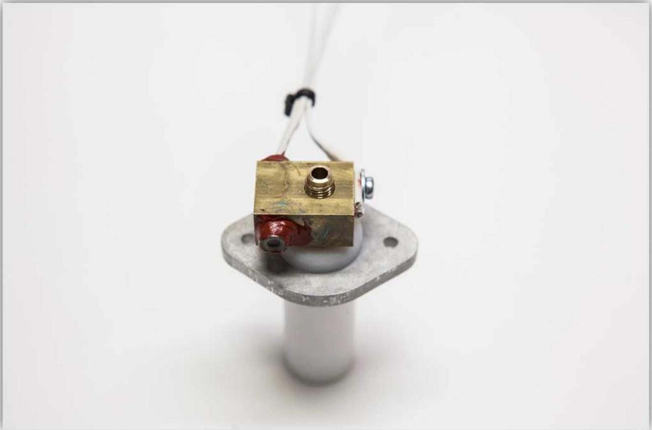
Befestigen Sie die Düse am kupfernen Zylinder. **Ziehen Sie fest an. Sie können den weißen Plastik-Zylinder lockern und einen anderen Schlüssel für den kupfernen Zylinder verwenden, um die Düse fest anzuziehen. Vergessen Sie nicht, den weißen Plastik-Zylinder wieder gut zu befestigen.**
