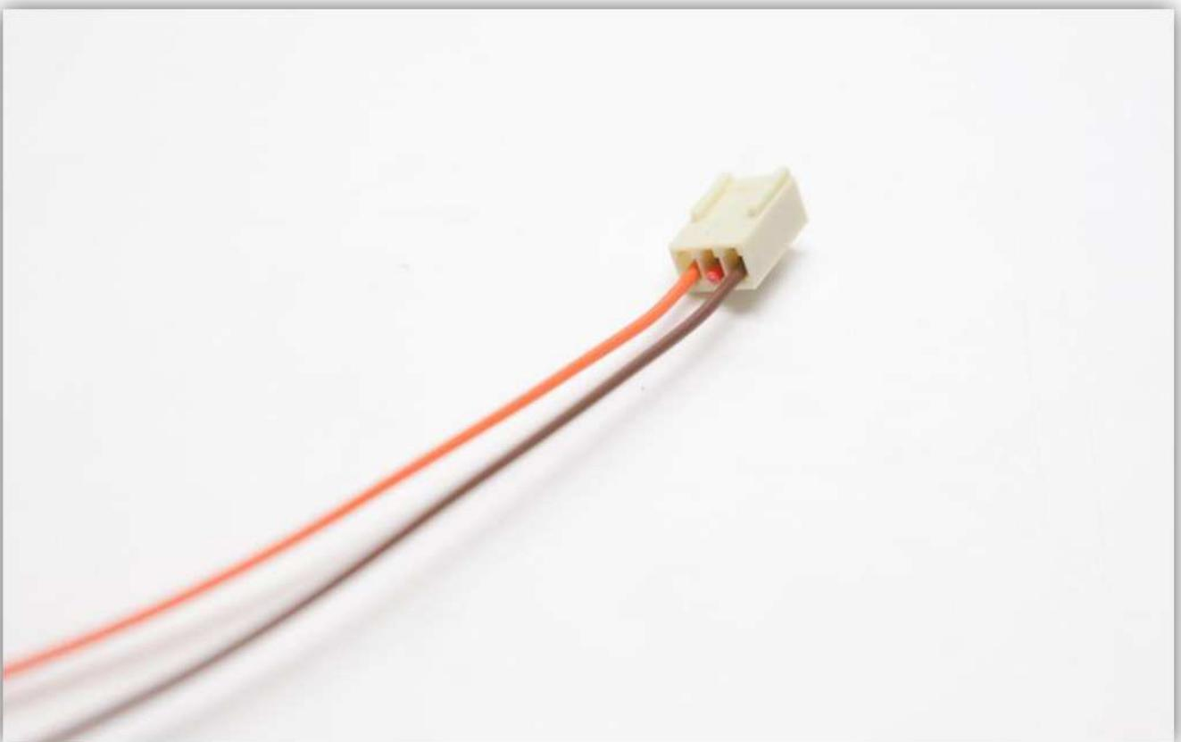
Stecken Sie die Buchse in den Anschluss auf der Controllerplatine (XSTOP).
