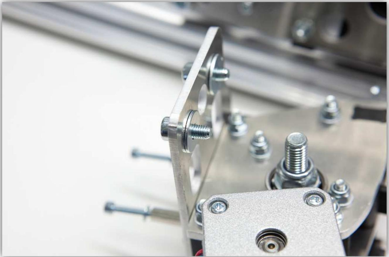
Lokalisieren Sie die zwei M5-Vierkantmutter. Diese haben Sie schon installiert und befinden sich an der Unterseite des Profils vom Extruderarm.
