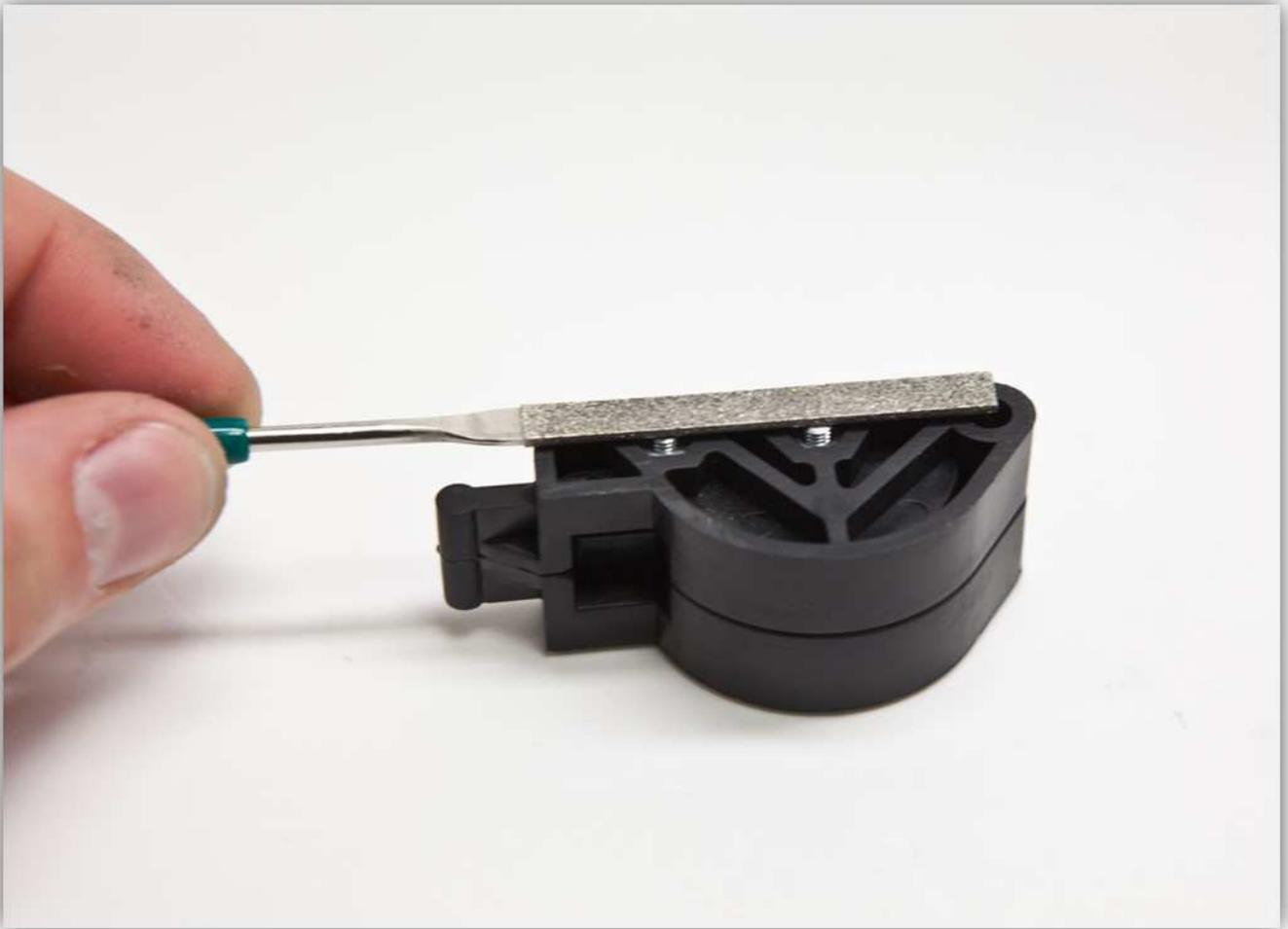
Feilen Sie, bis sich die Schrauben fast auf gleicher Höhe mit dem Kunststoff befinden.
