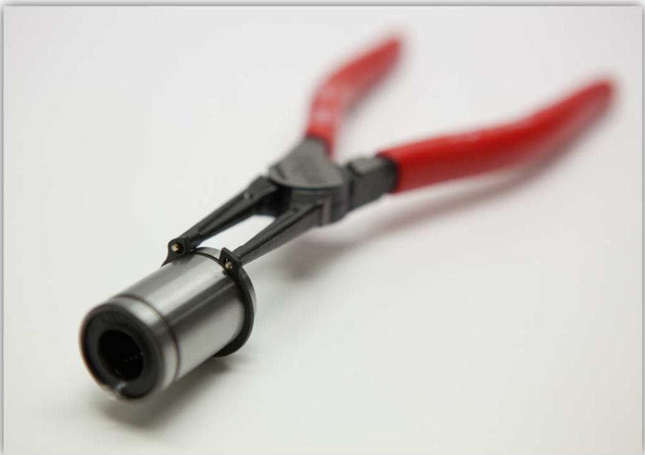
Schieben Sie den Lager mit einem Sicherungsring in eine der X-LAGERHALTERUNGEN:
