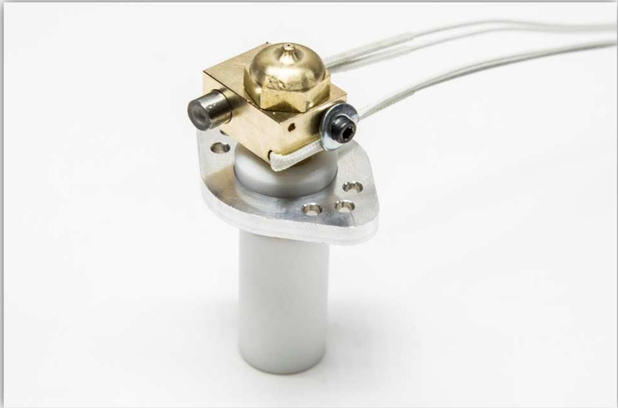
Stellen Sie das Multimeter auf **200 k $\Omega$**  und messen Sie die Anschlüsse vom NTC-Widerstand. Das Multimeter sollte einen Wert zwischen 70 und 100 k $\Omega$  anzeigen. Dies hängt davon ab, wie heiß der NTC-Widerstand ist. Ist der Messwert viel niedriger, dann ist der NTC-Widerstand möglicherweise kurzgeschlossen. Trennen und prüfen Sie den NTC-Widerstand. Befestigen Sie ihn danach wieder.
