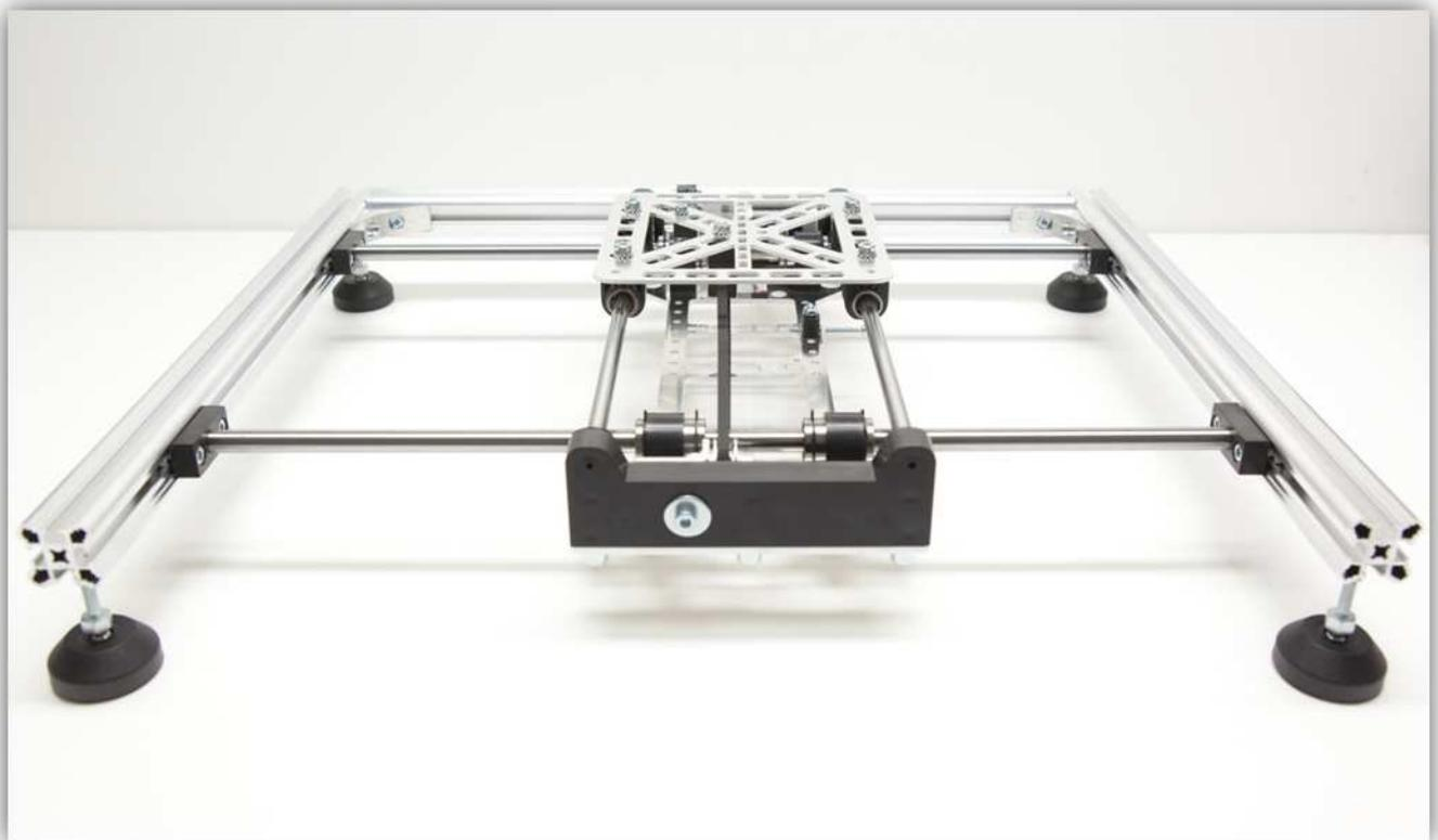
Schieben Sie den X-TISCH weiter bis der Abstand zwischen der ersten X-ROHRKLEMME und dem MONTAGEWINKEL am Ende des Rahmens etwa 4mm (0.16") beträgt. Vergewissern Sie sich davon, dass Sie den X-TISCH waagrecht und
