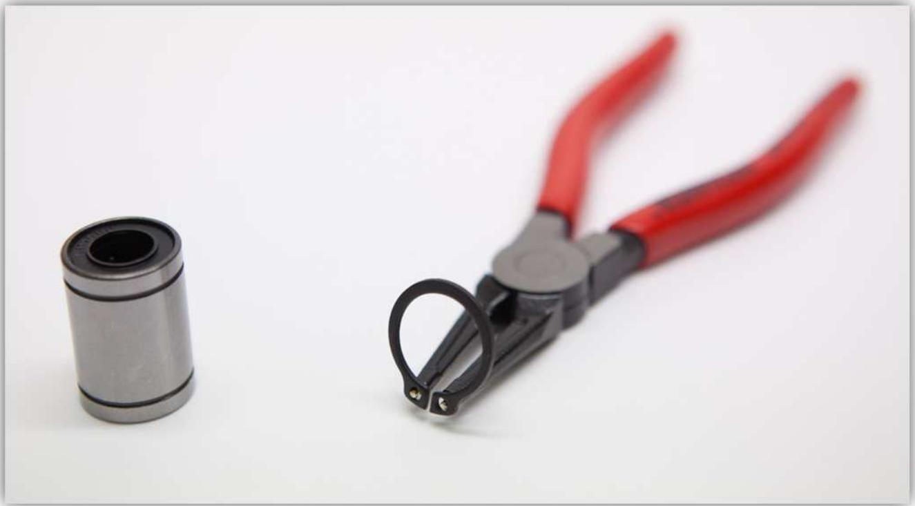
Bringen Sie den Sicherungsring mit der Sicherungsringzange vorsichtig am Linearlager (LM10UU) an.
