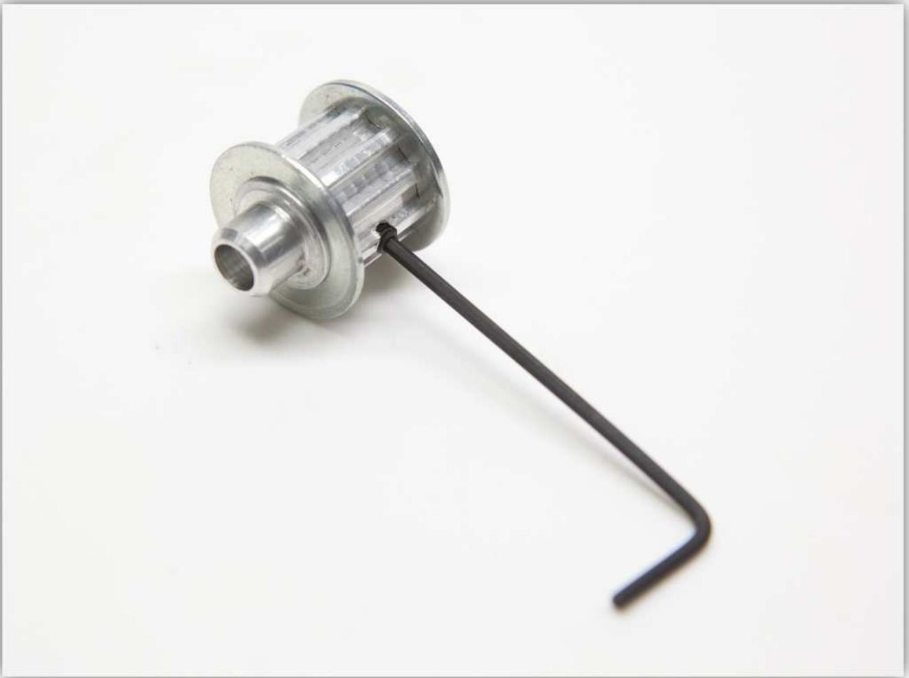
Schieben Sie die Riemenscheibe über die Motorwelle und ziehen Sie die kleine Madenschraube fest an (siehe Abb.).
