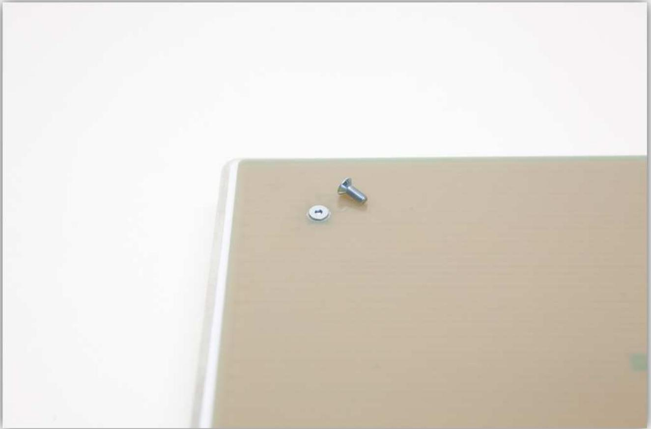
Verwenden Sie vier M3-Unterlegscheiben und 4 M3-Muttern, um die HEIZBETTPLATINE an der DRUCKBETTHALTERUNG zu befestigen.
