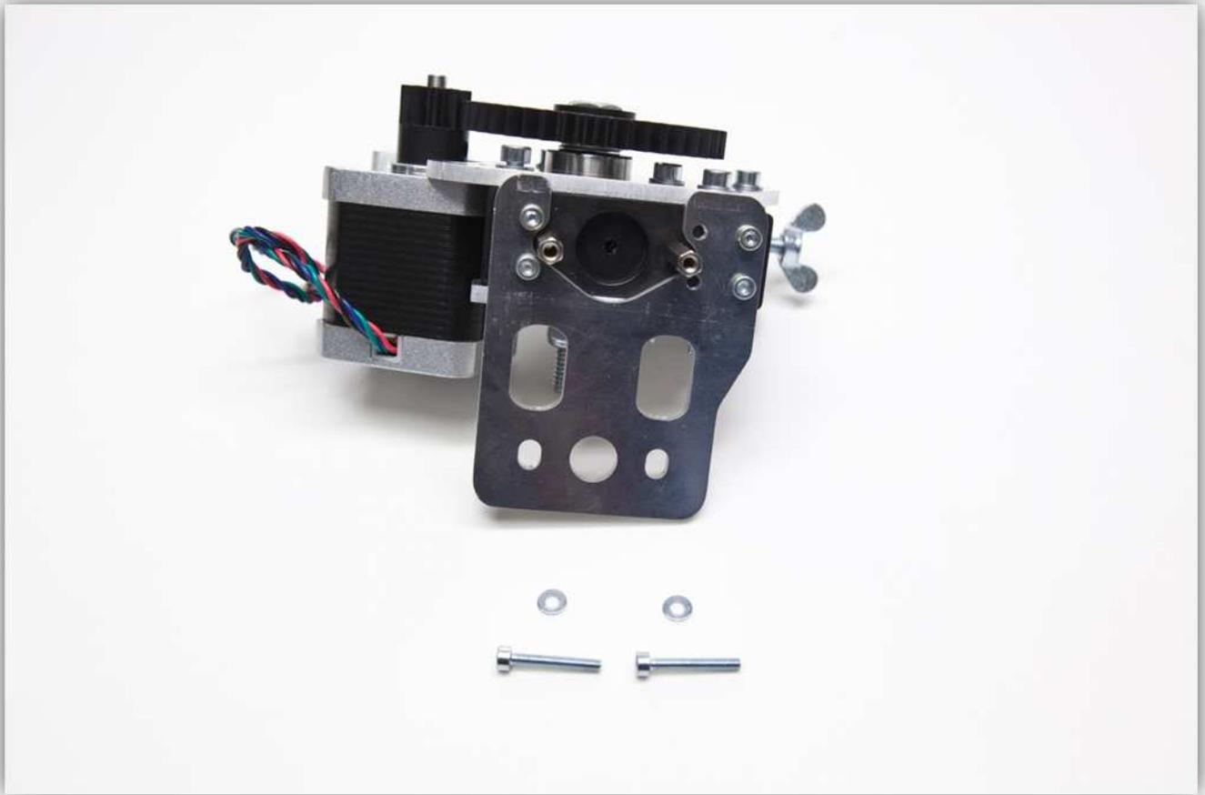
Befestigen Sie diese in den Abstandsbolzen für die spätere Verwendung (der Extruder wird mit diesen Schrauben montiert).
