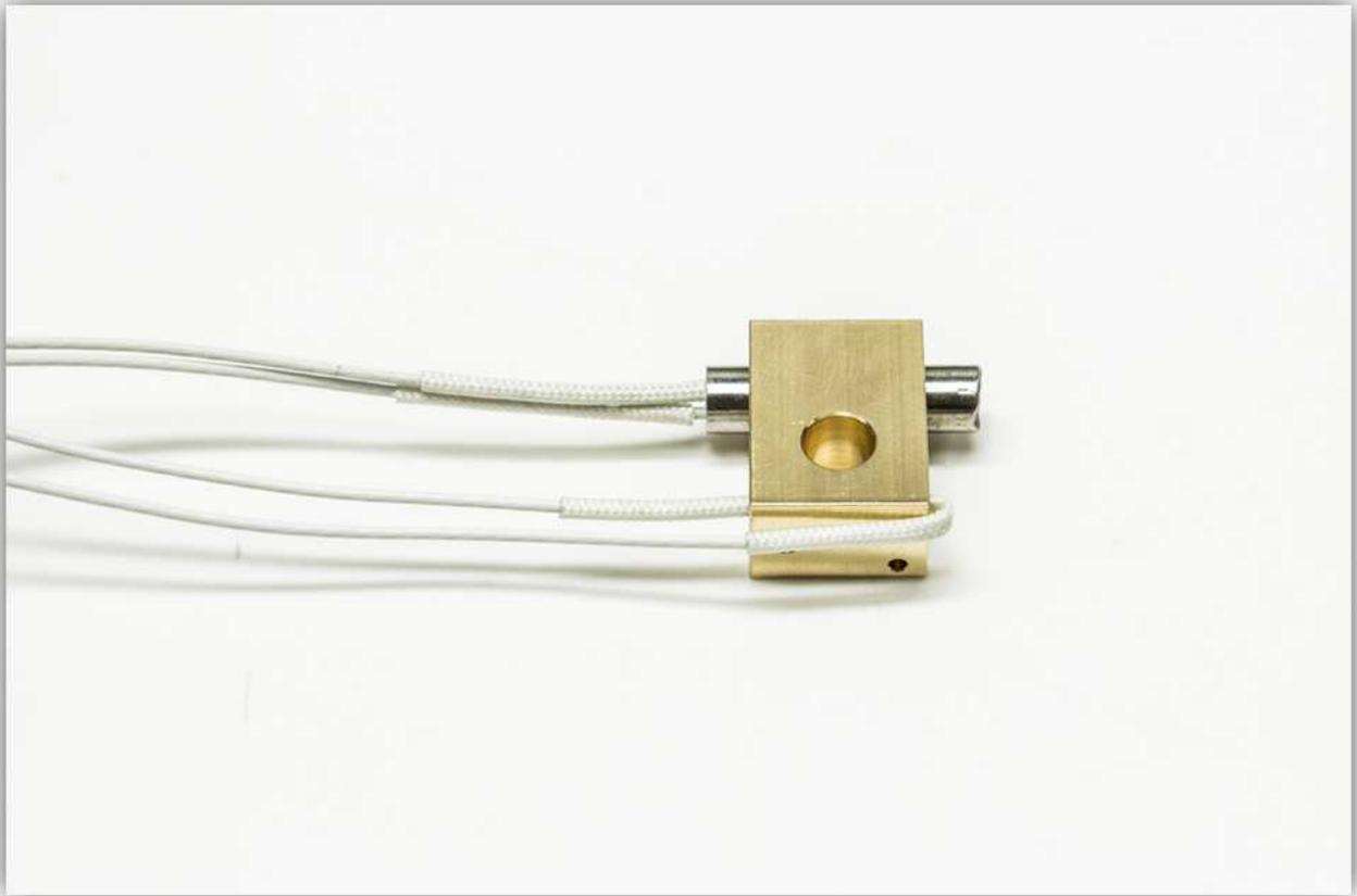
Befestigen Sie die Ader vorsichtig mit der kleinen Unterlegscheibe und der kleinen M2.5-Schraube am Heizblock.
