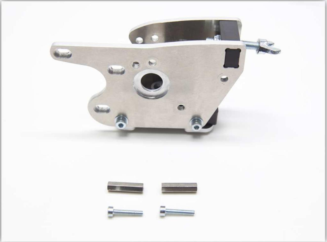
Schieben Sie die zwei Schrauben in die EXTRUDER BASIS (siehe Abb.).
