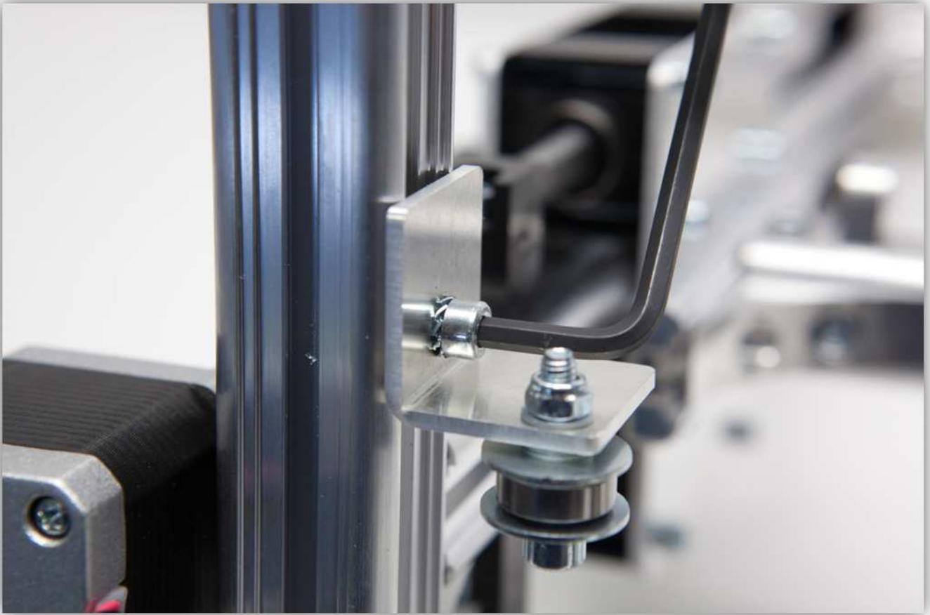
Nehmen Sie zwei kurz m2-Schrauben und zwei gezähnte M5-Unterlegscheiben und befestigen Sie die X-MOTORHALTERUNG an der schon montierten Vierkantmutter der rechten Seite des Rahmens. **Ziehen Sie die Schraube noch nicht ganz fest.**
