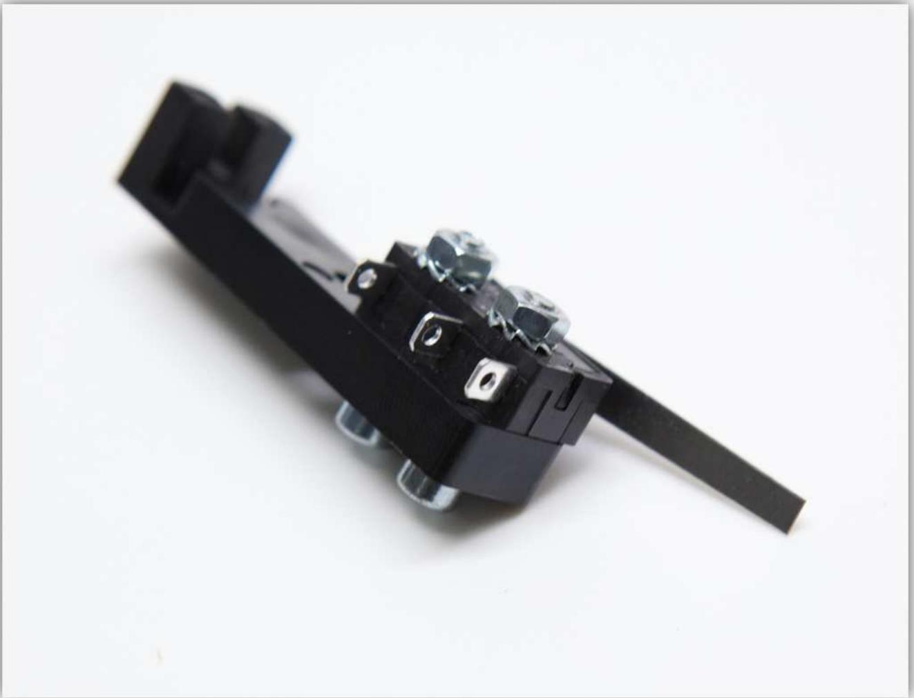
Schneiden Sie 10mm (0.39") vom Hebel des Microschalters ab. Achten Sie darauf, dass Sie nicht zu viel abschneiden.
