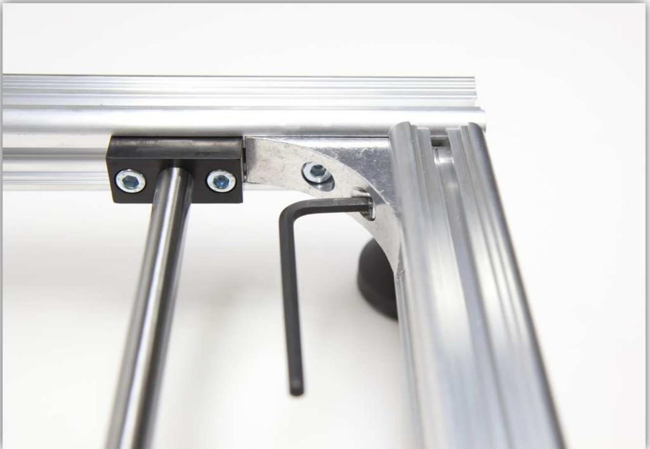
Überprüfen Sie nochmals, ob die X-LAGERKLEMMEN noch immer korrekt befestigt sind. Ist dies der Fall, dann ziehen Sie die Schrauben der Klemmen fest an. Achten Sie darauf, dass sich der X-Tisch frei bewegen kann.
