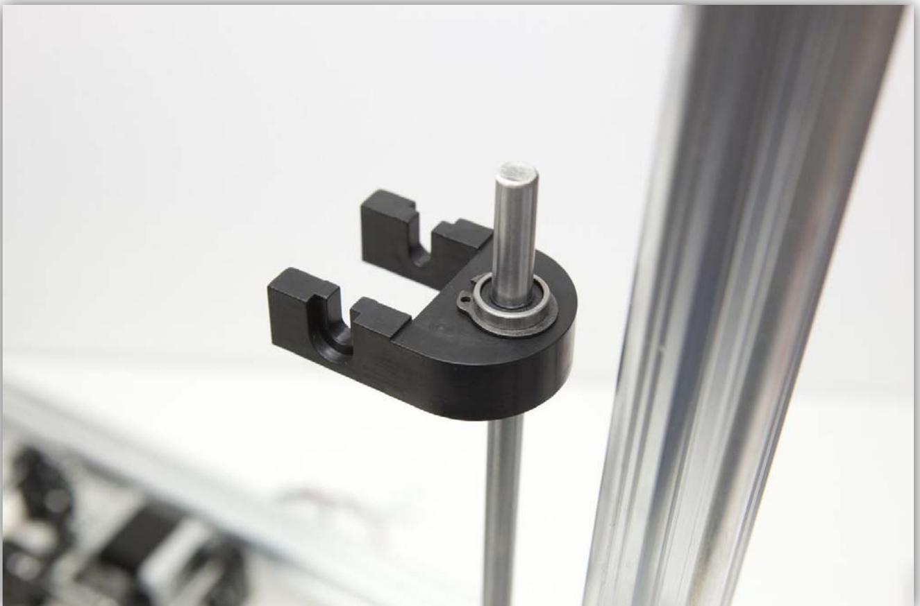
Schieben Sie eine der M5-Schrauben (mit Unterlegscheibe und Vierkantmutter) in das ALUMINIUMPROFIL und befestigen Sie eine KLEINE Z-ROHRKLEMME über diese Schraube. Diese sollte auf die Stange passen.
