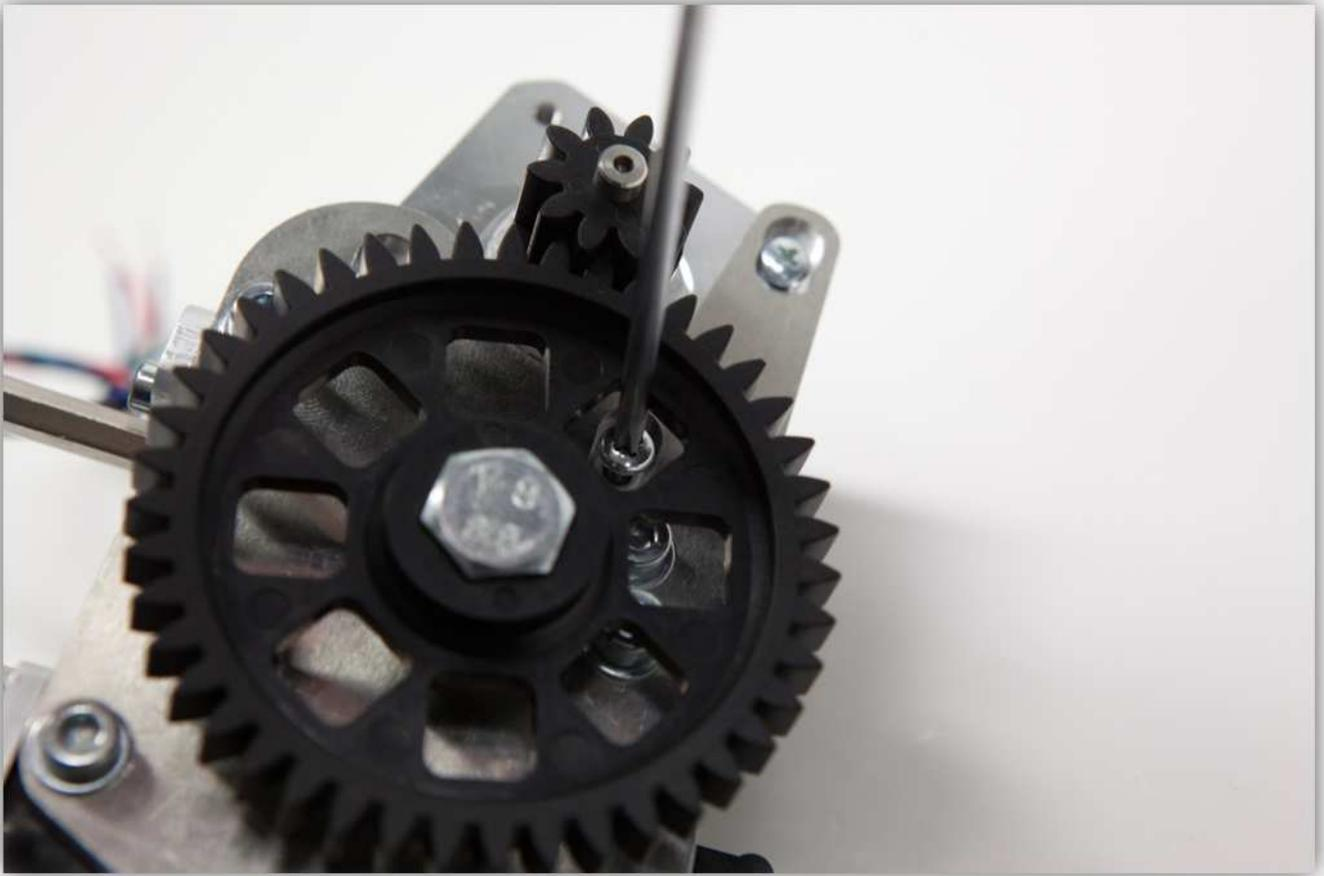
Installieren Sie den Motor so, dass die Zahnräder verzahnen (siehe Abb.). **Ziehen Sie die Schrauben nun fest an.**
