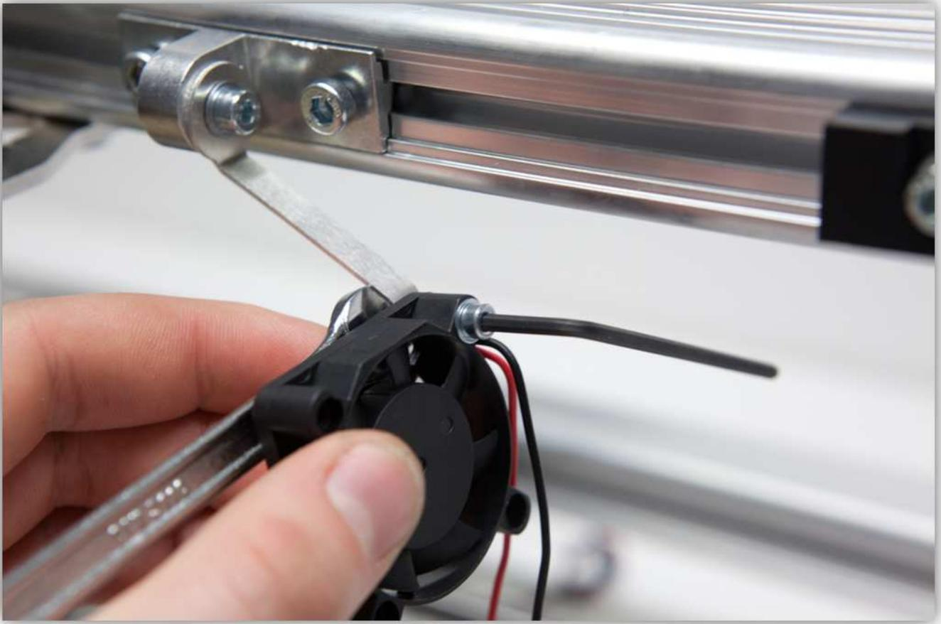
Bewegen Sie die BEFESTIGUNGSPLATTE FÜR DEN LÜFTER in die Richtung des Extruders und ziehen Sie fest an.
