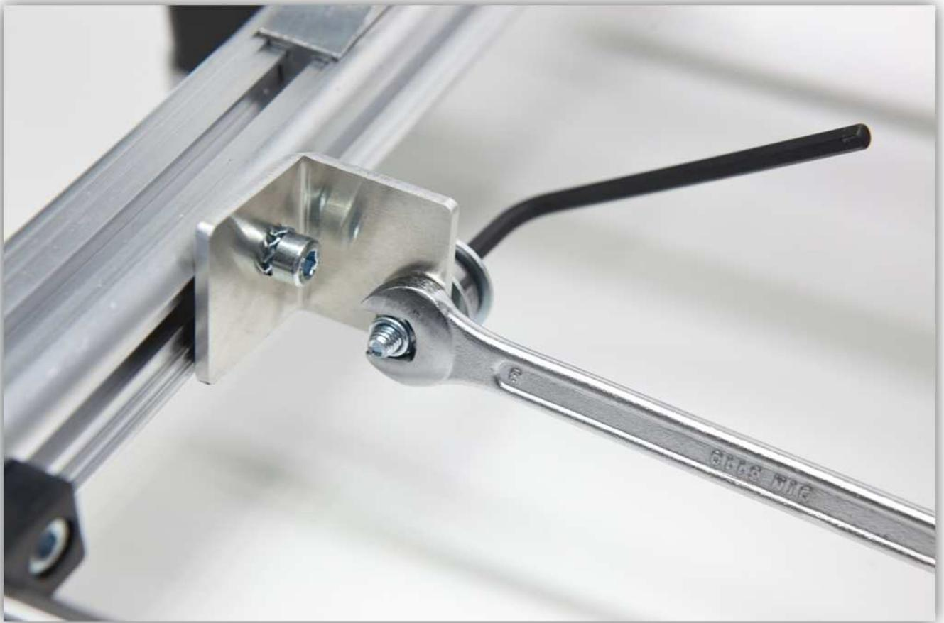
Betrachten Sie die Montage von unten her, dann sollten die X-RIEMENKLEMMEN und die X-RIEMENSCHLEIBE bündig liegen. Schieben Sie die X-RIEMENSCHLEIBEHALTERUNG solange, bis diese und die zwei X-RIEMENKLEMMEN ausgerichtet sind. Ziehen Sie danach die Schraube, die diesen Teil am Rahmen befestigt, fest. **Beachten Sie dass, den montierten Teil perfekt horizontal steht.**
