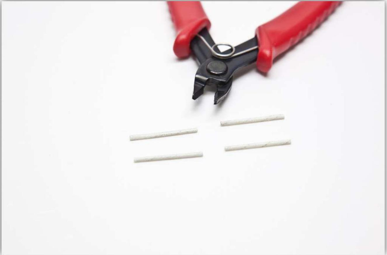
Schneiden Sie die Adern des Heizkörpers in der Mitte durch.
