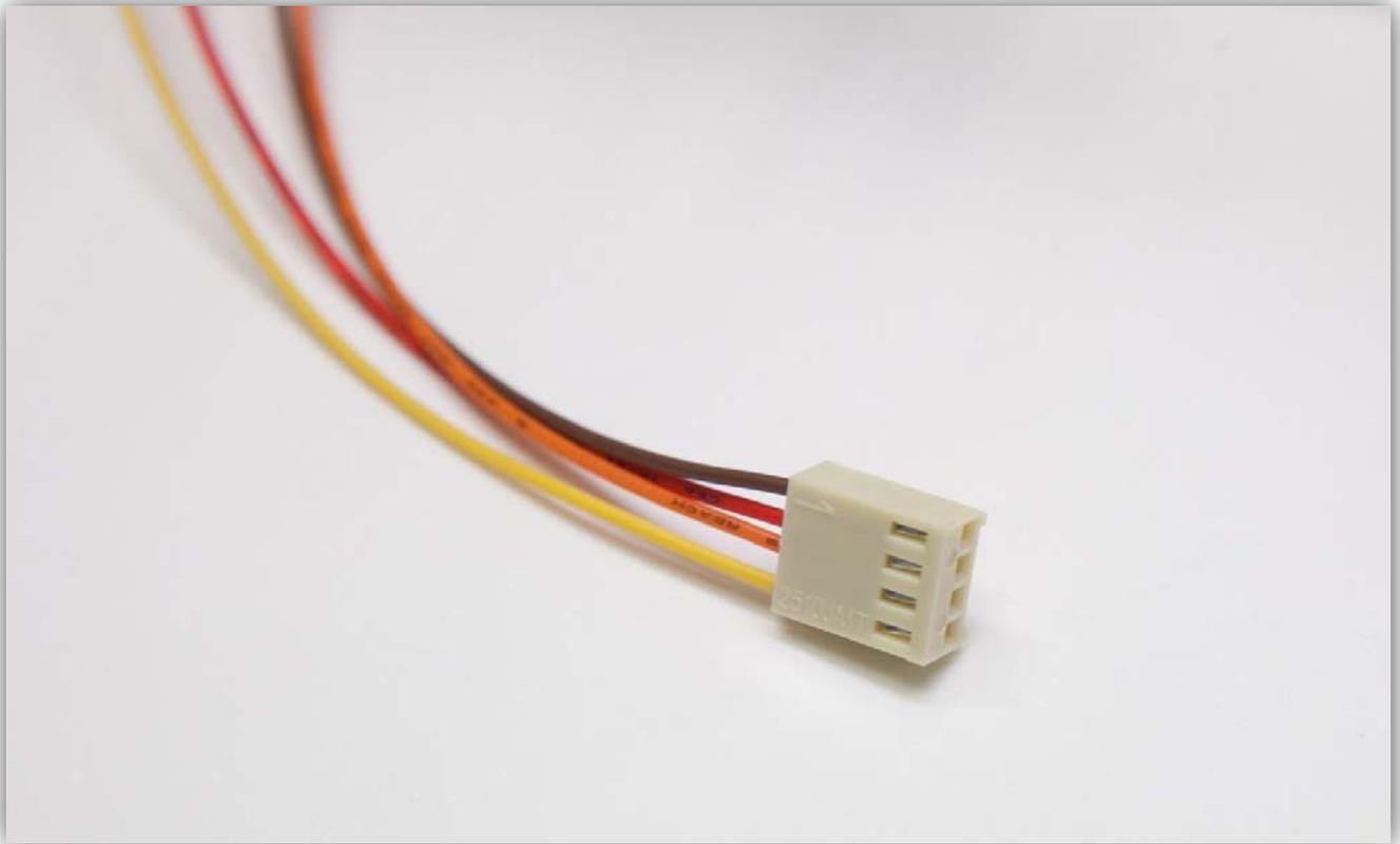
Stecken Sie die Buchse in den Anschluss auf der Controllerplatine (HEATER1).
