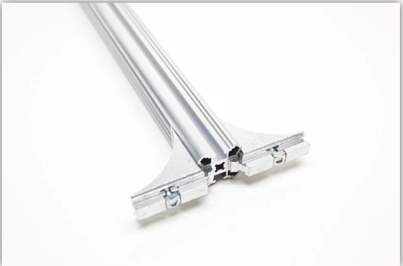
Schieben Sie den montierten Teil in das rechte Profil des RAHMENS. Schieben Sie es weiter bis sich der Mittelpunkt 16cm (6.3") vom Rand des Rahmens befindet.
