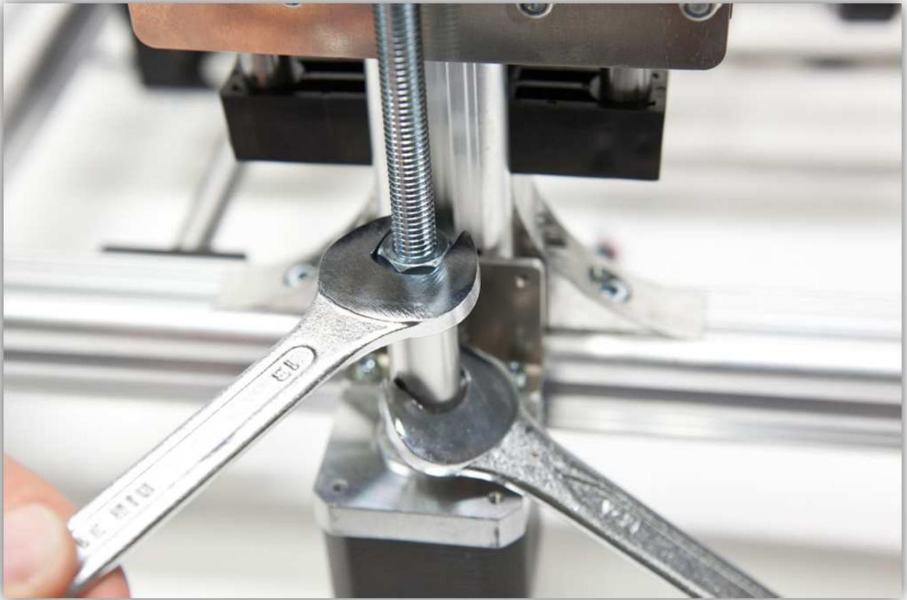
Befestigen Sie die Z-HALTERUNG A am TISCH. **Ziehen Sie diese Schrauben noch nicht ganz fest.** Drehen Sie die Gewindestange bis die M8-Schraube exakt in der Z-HALTERUNG A passt.
