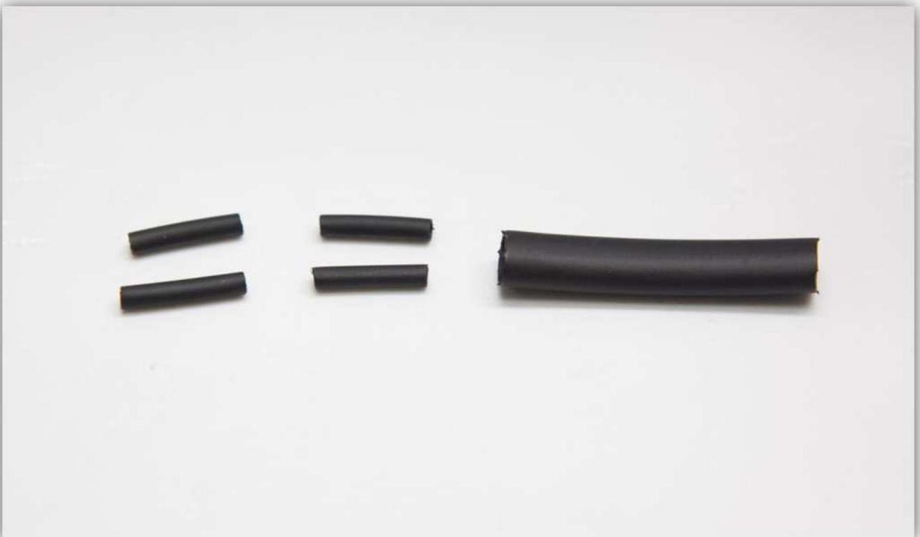
Schieben Sie den großen Schrumpfschlauch über die 4 Adern der Steckbuchse.
