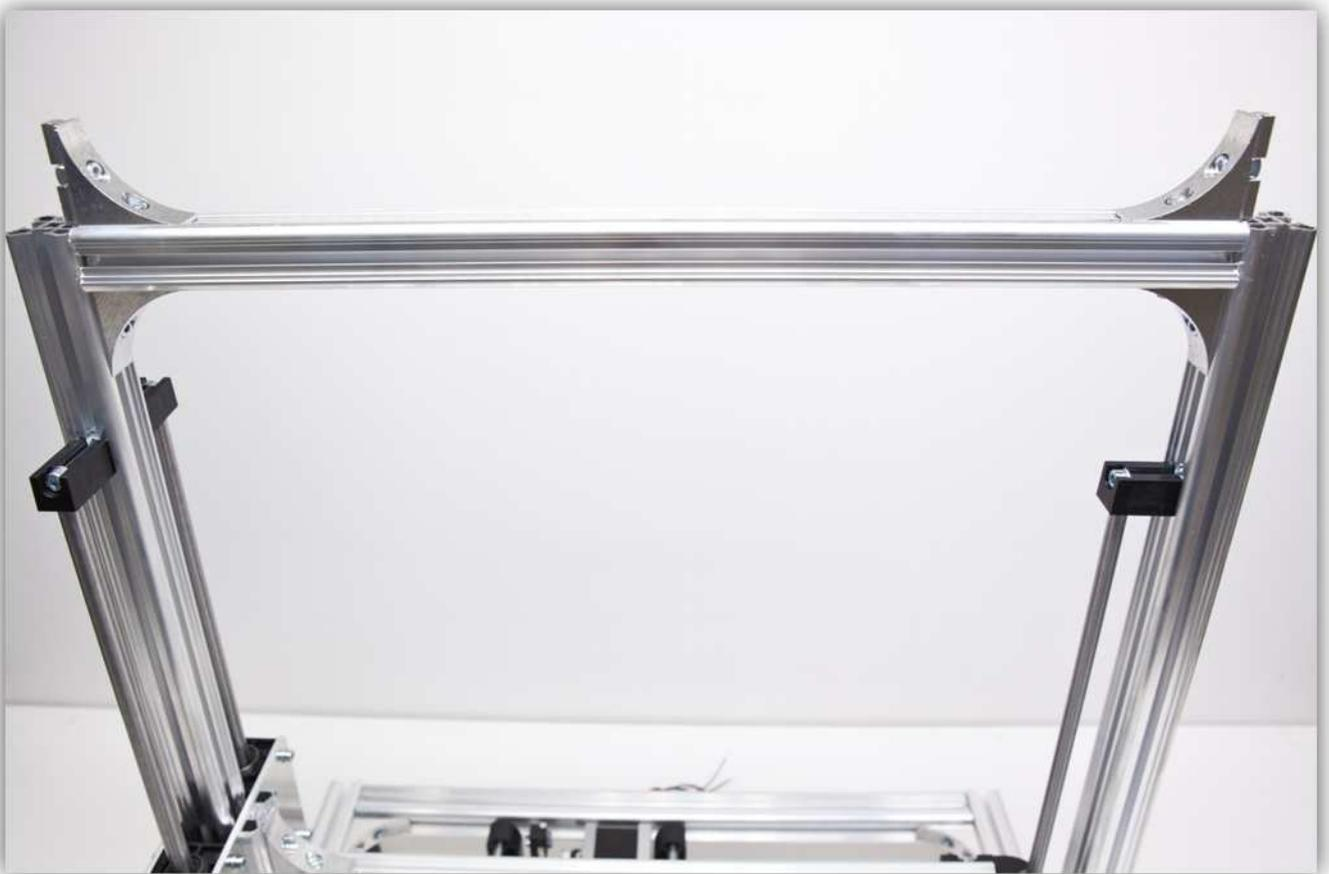
Schieben Sie das ALUMINIUMPROFIL nach unten bis die obere Seite der MONTAGEWINKEL sich auf gleicher Höhe wie die obere Seite des Rahmens befindet.
