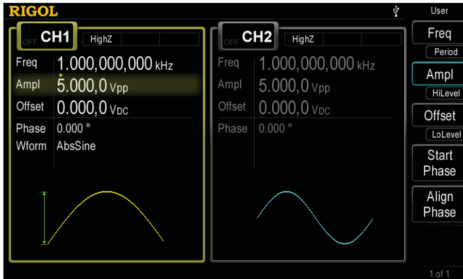
Bild 10-6 Taste User drücken und Parameter editieren
