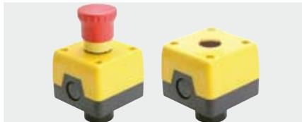
Set Not-Aus-Schalter mit positiver mechanischer Wirkung nach EN 60947-5-1 und EN ISO 13850, mit VF KIT31-VF KIT29 zu kombinieren. Schutzgrad IP65.
