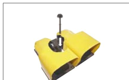
Außer der Möglichkeit zwei bis vier einzelne Fußschalter zusammenzusetzen, bieten die Verbindungsvorrichtungen die Möglichkeit, eine Metallstange anzubringen, das eine Verdrahtung zwischen den Fußschalterkontakten und dem Not-Aus-Schalter erlaubt, verdrahtet an der gleichen Stange mit einem Schutzgrad IP65.
