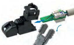
Schwarze Montagehilfe abziehen und die Platine mit den angeschlossenen Adern in das Steckergehäuse einführen. Das Adermanagement ist verdrehsicher gestaltet und kann nur in der richtigen Orientierung in das Steckergehäuse geschoben werden.
