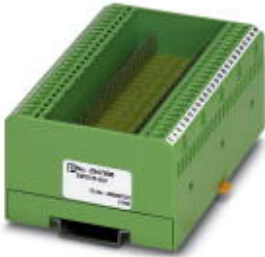
Bestückungs-Modul, bestehend aus Gehäuse, Anschlussklemmen MKDS 3 und Leiterplatte
