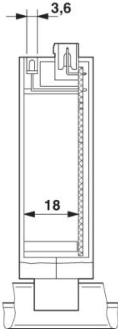
Maximale Höhe der Bauteile auf der Leiterplatte
