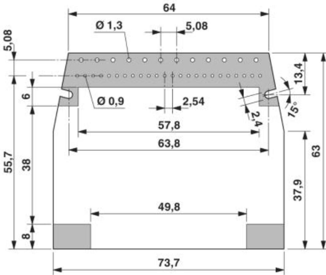
Lötseite des Leiterplattenlayouts1 = bestückbare Fläche
