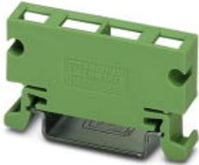
Seitenelement mit Fuß, jedoch ohne Leiterplattenführung, beschriftbar mit SS-ZB, Montage in Längsrichtung zur Tragschiene NS 35/7,5. Höhe: 36 mm, Breite: 10 mm, Länge: 45 mm.
