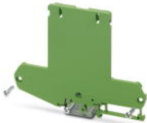
Seitenelement mit Fuß, hohe Ausführung, links, für 60 mm breite U-Profil-Abdeckung.
