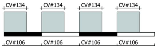
Ein Wert von 50 in CV#134 würde bewirken, dass Ein- und Ausschaltdauer gleich lang sind, bei einem Wert von 100 wäre das Licht dauerhaft eingeschaltet.
