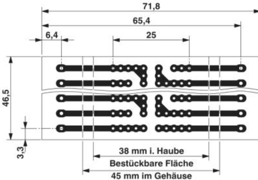
Rastermaß 5 mma = Bestückbare Fläche 38 mm in der Haube = Bestückbare Fläche 45 mm im Gehäuse
