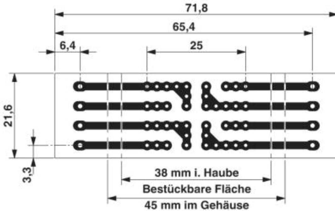
Rastermaß 5 mma = Bestückbare Fläche 38 mm in der Haube = Bestückbare Fläche 45 mm im Gehäuse
