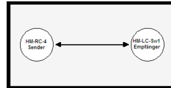
Abbildung 55: Kommunikation bei einer direkten Geräteverknüpfung ohne HomeMatic Zentrale
