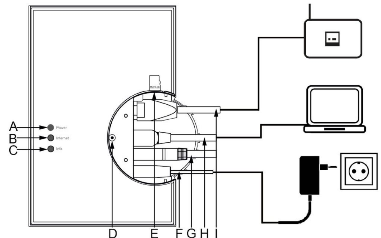
Abbildung 1: Anschlüsse der HomeMatic CCU2
