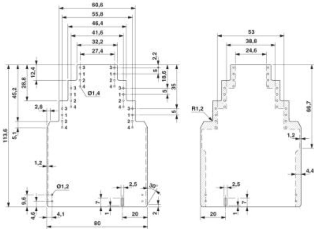
Maßbild der Leiterplatte ME... bei Verwendung des dreistückigen Oberbauteiles
