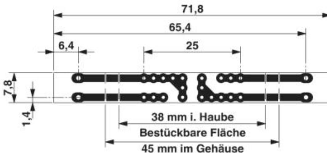
Rastermaß 5 mma = Bestückbare Fläche 38 mm in der Haube = Bestückbare Fläche 45 mm im Gehäuse
