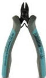
ESD Elektronik-Seitenschneider, runder Kopf, ohne Fase, mit Öffnungsfeder, entspiegelt und phosphatiert, 2-Komponenten Griff, Schneidkapazität: weich 0,2 - 2,0 mm; mittelhart 1 mm Durchmesser
