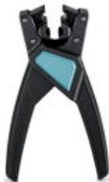
Abisolierzange, zum Entmanteln von Leitungen für Kabelausschnitte, Leitungsabgriffe und Schirmanschlüsse von 8 - 9 mm Durchmesser, bis 1,2 mm Isolationsstärke, Abisolierlänge ab 20 mm
