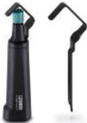
Abisolierwerkzeug, zum Entmanteln von Leitungen von 4,5 mm - 40-mm-Ø, Isolationsstärke bis 4,5 mm, schwenkbares Messer für Rund-, Längs- und Spiralschnitte
