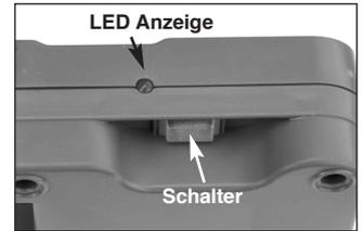
7. Lassen Sie den Schalter an der Akkubox in der Stellung „0“ (Aus) und laden Sie den eingebauten Akkupack einige Stunden bei Sonneneinstrahlung auf.
