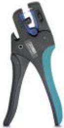
Abisolierwerkzeug, für Leitungen und Leiter (speziell auch für kurz- und erdschlusssichere Leitungen) 1,5 - 6 mm<sup>2</sup>, selbstjustierend, Abisolierlänge bis 18 mm, Schneidvermögen bis 10 mm<sup>2</sup> flexibel /1,5 mm<sup>2</sup> starr, Abisoliermesser austauschbar
