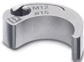
Steckaufsatz zur Montage von freikonfektionierbaren SACC M12-Steckverbindern, außer M12-Steckverbinder mit QUICKON-Schnellanschlusstechnik, für 4 mm Sechskantantrieb
