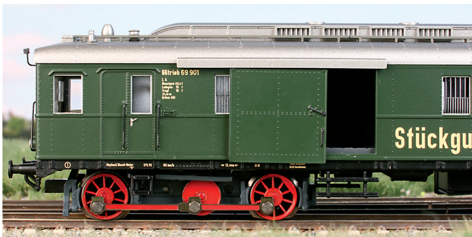
Das Antriebsdrehgestell mit Blindwelle. Die Beschriftung ist sauber aufgedruckt, die Türen lassen sich öffnen
