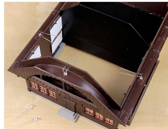
In passgenauen Bohrungen bleiben die eingesteckten LEDs durch die mechanische Spannung an ihrem Platz
