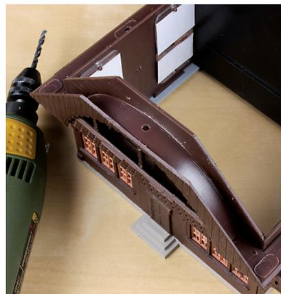
Die Balkone sind nicht für eine Beleuchtung vorgesehen. Sie erhalten mittig Bohrungen für die LEDs
