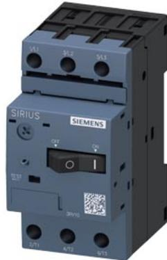
Leistungsschalter Baugröße S00 für den Motorschutz, CLASS 10 A-Auslöser 0,7...1 A N-Auslöser 13 A Schraubanschluss Standardschaltvermögen
