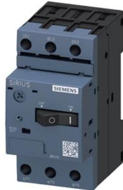
Leistungsschalter Baugröße S00 für den Motorschutz, CLASS 10 A-Auslöser 1,4...2 A N-Auslöser 26 A Schraubanschluss Standardschaltvermögen
