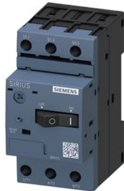
Leistungsschalter Baugröße S00 für den Motorschutz, CLASS 10 A-Auslöser 9...12 A N-Auslöser 156 A Schraubanschluss Standardschaltvermögen
