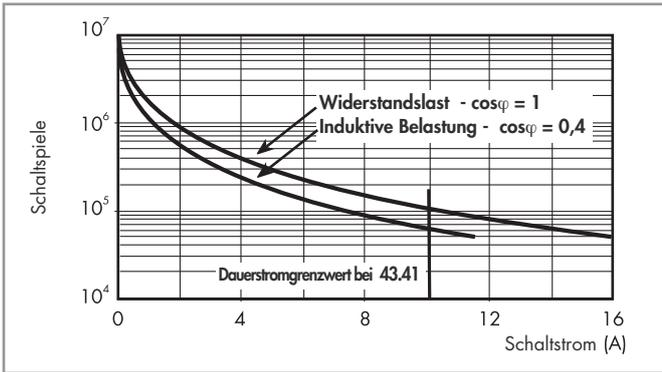
**H 43 - Gleichstromschaltvermögen bei DC1 - Belastung**
