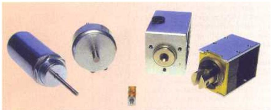
■ Bild 2: Aktive Elektromagnete: Zylindermagnet mit Druckstift, Kurzhubmagnet, nahtloser Industriebhubmagnet mit doppelt gelagertem Tauchkern für maximale Zyklen, Low-Cost-Hubmagnet mit ziehender Wirkung und Arretierung, Miniaturhubmagnet mit einer Auflagefläche kleiner als ein 1-Cent-Stück (Mitte)
