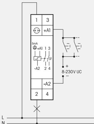
**oder** Steuerspannung 230V mit Glühlampenstrom bis 5mA
