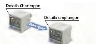
Die Sensoren können mit einem Mastersensor verbunden werden. Von diesem Mastersensor lassen sich dann alle Einstellungsdetails an die anderen Sensoren übertragen. Wenn mehrere Sensoren dieselben Einstellungen benötigen, lassen sich dadurch Einstellungsfehler vermeiden und eine schnelle Anpassung ist gewährleistet.
