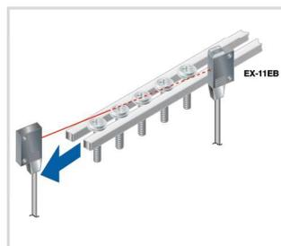
**Erkennung einer Waferkassette**
